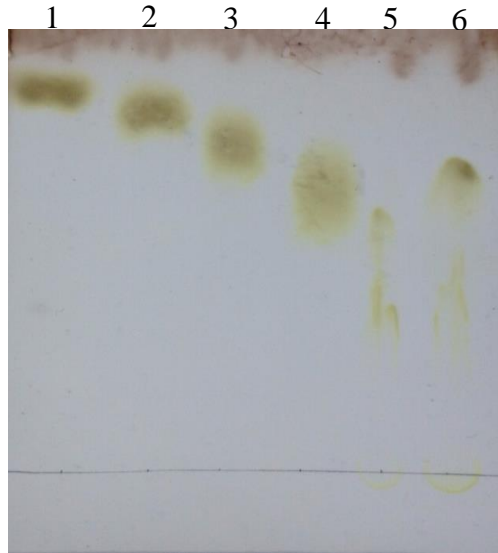
Şekil 23. %1'lik nişastanın saf enzimle reaksiyonu sonucu oluşan parçalanma ürünleri, 1: Glukoz, 2: Maltoz, 3: Maltotrioz, 4: Maltotetroz 5: 6 saat hidroliz ürünleri, 6: 12 saat hidroliz ürünleri
