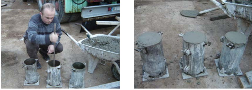
Şekil 2.29. Betondan numuneler alınması
