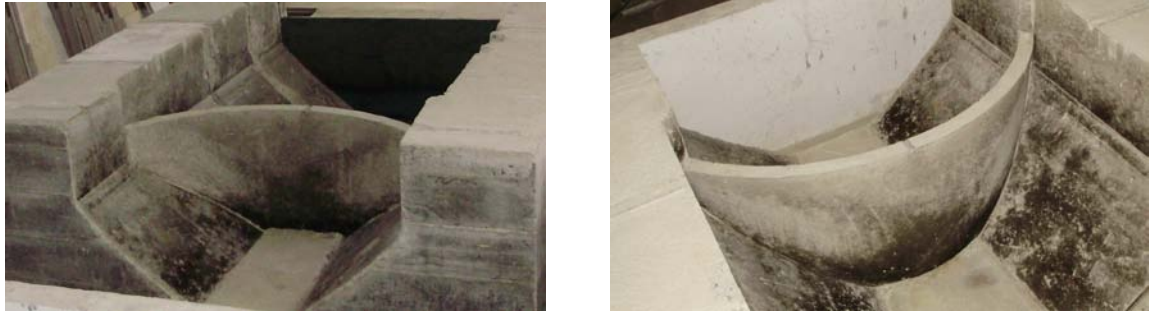
Şekil 2.105. Laboratuarda oluşturulan baraj modelinin üstten ve önden görünüşleri
