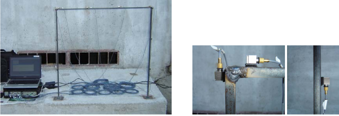
Şekil 2.17. İki boyutlu çerçeve modeldeki deneysel ölçüm düzeni ve ivmeölçer yerleşimi
