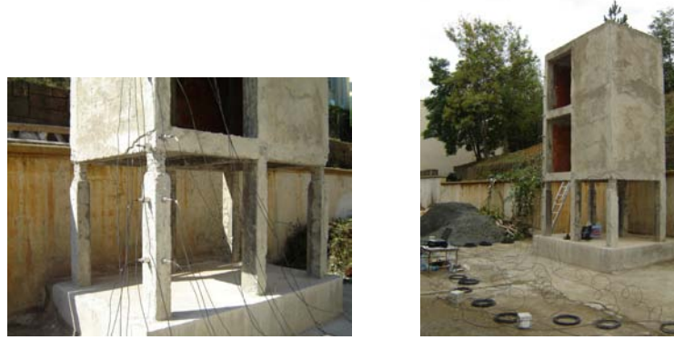
Şekil 2.85. Üç katlı betonarme bina modelin Hasar 6 durumu
