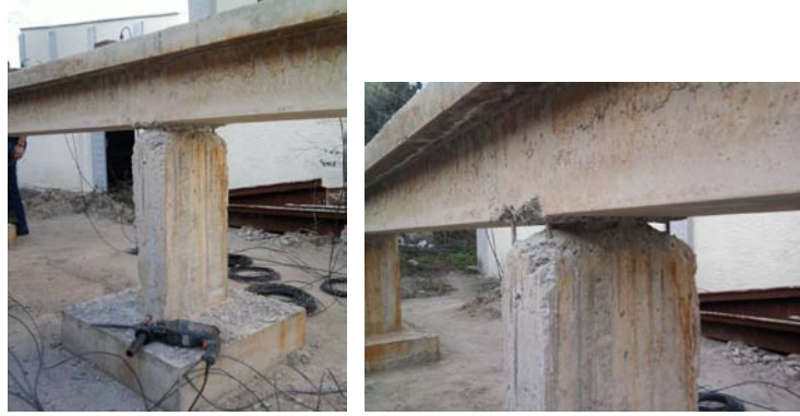
Şekil 2.98. Köprü modelde kolon üst ucu hasarı
