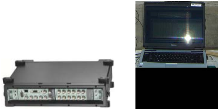
Şekil 1.6. B&K3560 tipi on yedi kanallı veri toplama ünitesi
