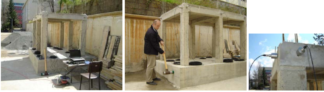
Şekil 2.34. Tek katlı betonarme bina modelin hasarsız durum ölçümlerine ait görüntüler
