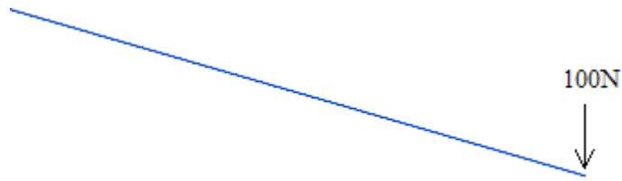
Şekil 3.5. Konsol kiriş model üzerinde statik yükleme durumu
