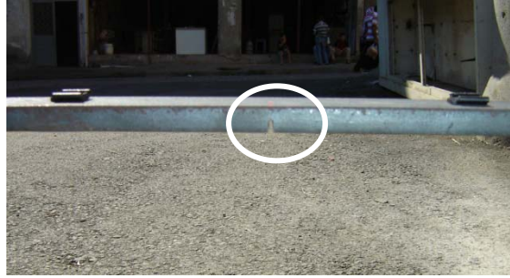
Şekil 2.10. Konsol kiriş modelde oluşturulan hasar durumu
