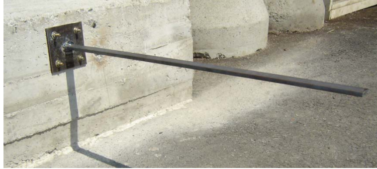
Şekil 2.3. Laboratuvar ortamında oluşturulan konsol kiriş model
