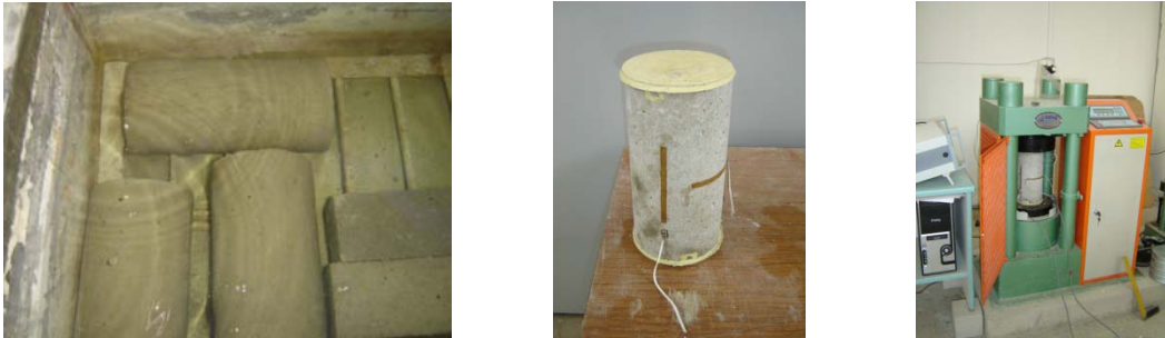
Şekil 2.30. Beton numunelerde yapılan beton dayanımı ve elastisite tayini deneyleri
