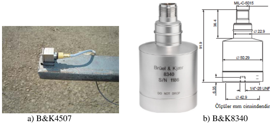
Şekil 1.5. B&K4507 ve B&K8340 tipi tek eksenli ivmeölçerler
