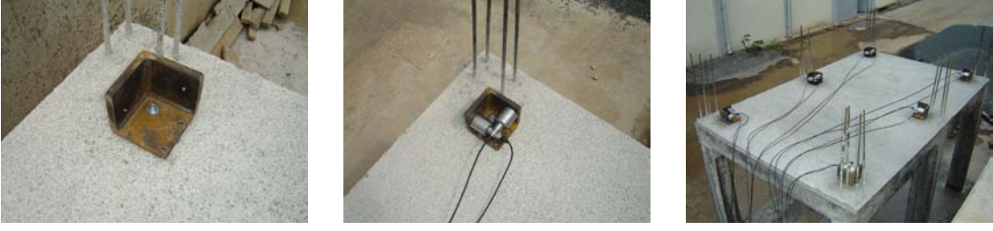
Şekil 2.57. Üç katlı betonarme bina modelde ivmeölçer yerleşimi
