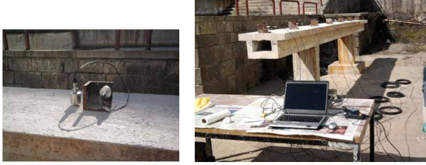
Şekil 2.94. Köprü model üzerinde ivmeölçer yerleşimi ve ölçüm düzeni
