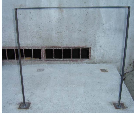
Şekil 2.14. Laboratuarda oluşturulan iki boyutlu çerçeve model ve mesnet birleşimleri
