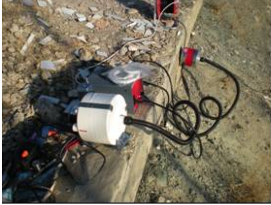
a) Sarsıcı sistemi (sarsıcı, soğutucu ve güç ünitesi)
