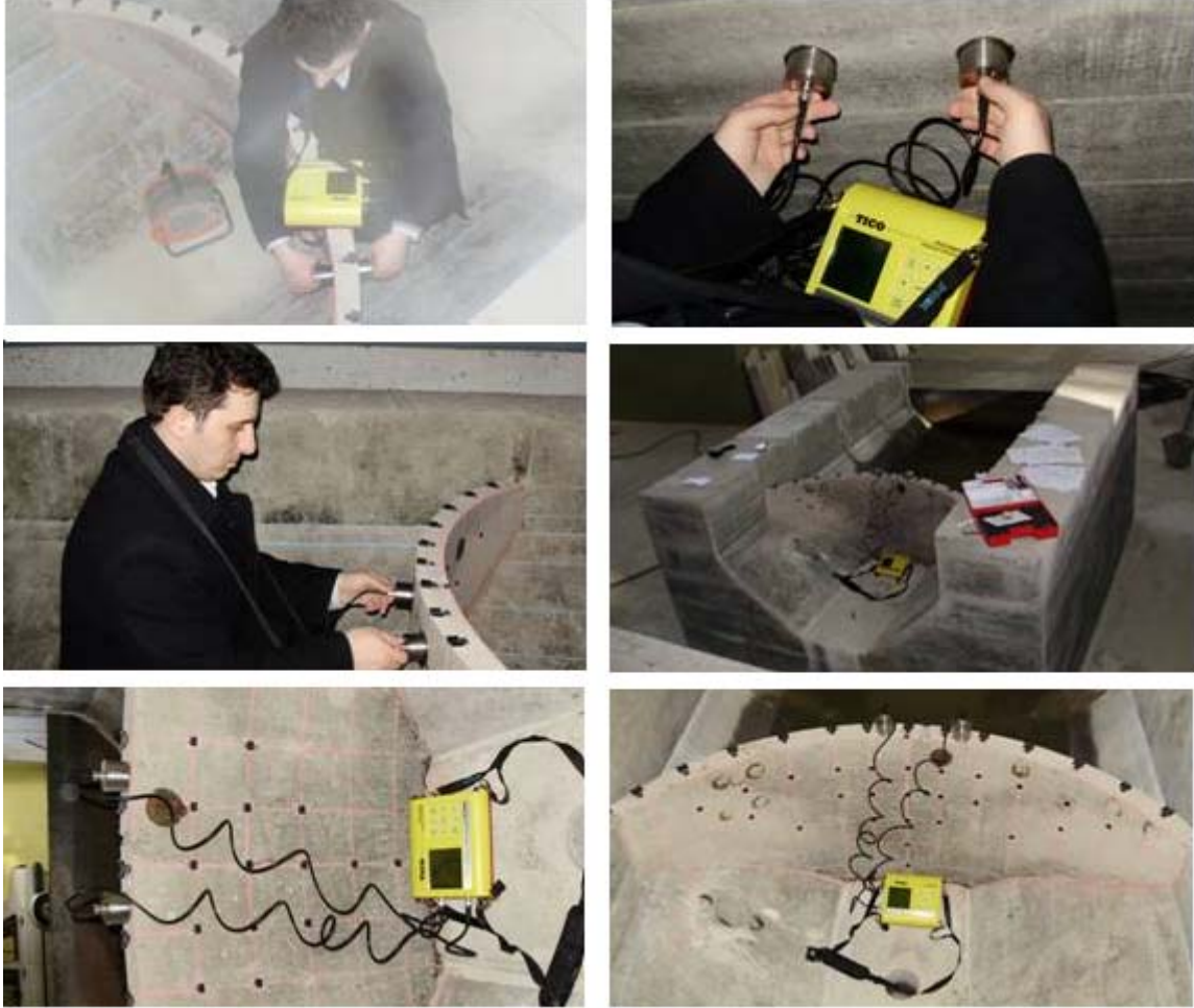
Şekil 24. Tip-1 kemer barajında yapılan ultrasonik hız testlerine ait bazı fotoğraflar
