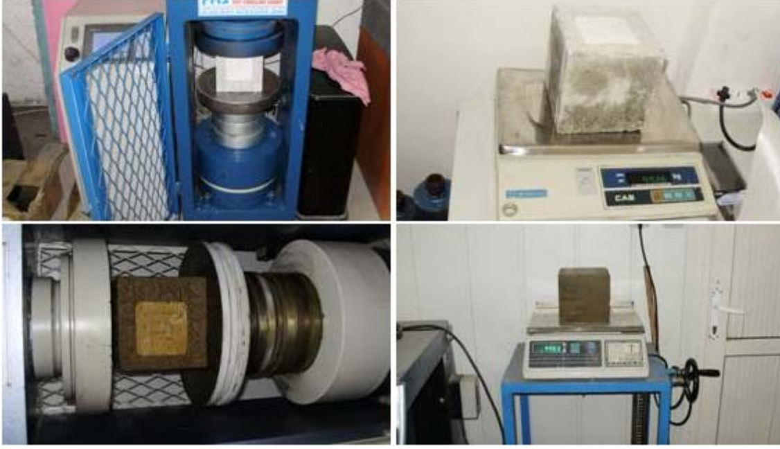
Şekil 21. Küp numunelerin tek eksenli basınç deneylerinden bazı fotoğraflar
