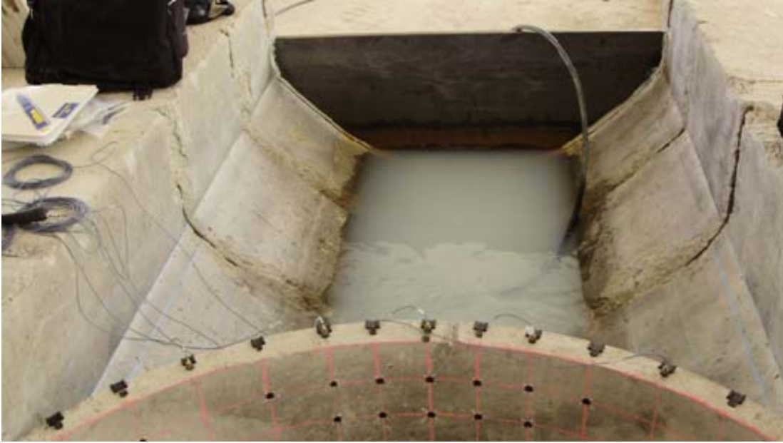
Şekil 84. Tip-1 kemer barajında H_z1 durumu için gerçekleştirilen zorlanmış titreşim testi
