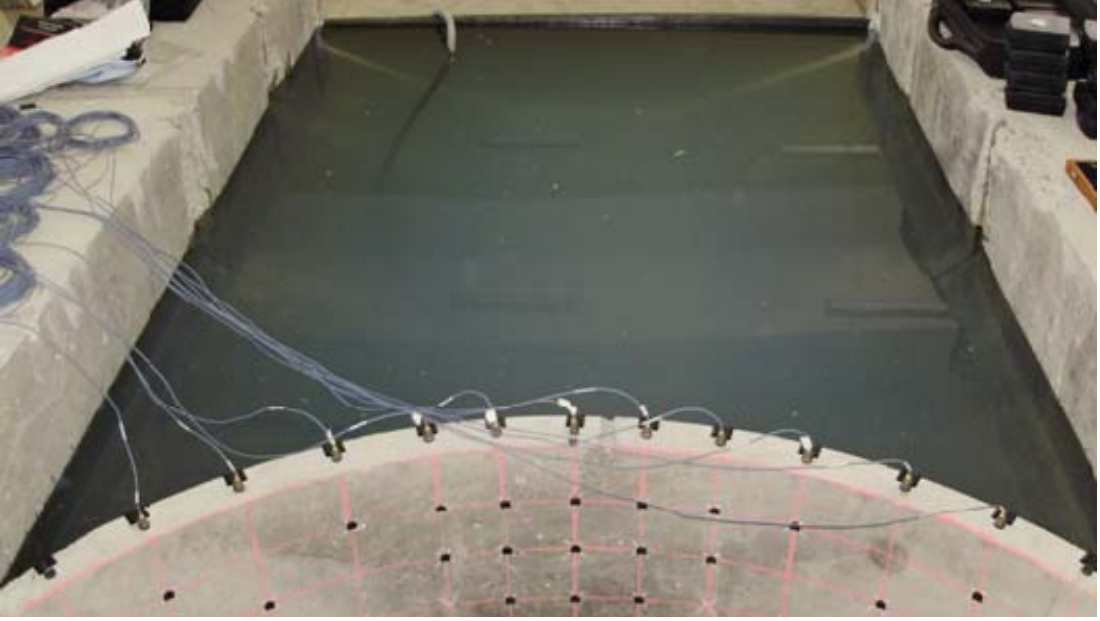
Şekil 51. Tip-1 kemer barajında Hç6 durumu için gerçekleştirilen çevresel titreşim testi
