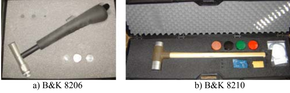
Şekil 3. B&K 8206 ve 8210 tipi darbe çekiçleri
