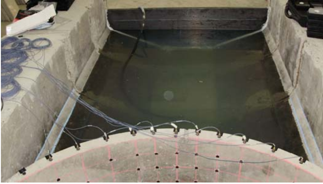
Şekil 49. Tip-1 kemer barajında Hç4 durumu için gerçekleştirilen çevresel titreşim testi
