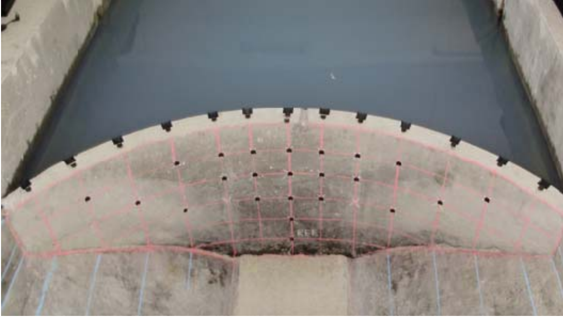
Şekil 89. Tip-1 kemer barajında H_z6 durumu için gerçekleştirilen zorlanmış titreşim testi
