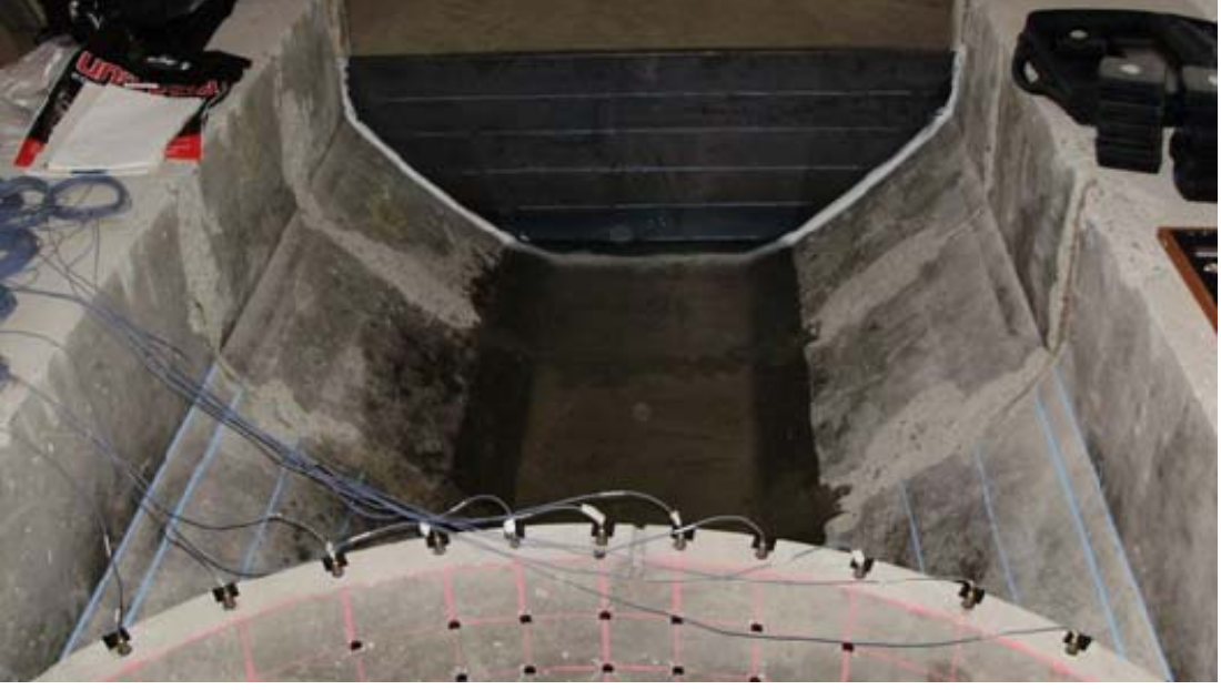
Şekil 46. Tip-1 kemer barajında Hç1 durumu için gerçekleştirilen çevresel titreşim testi
