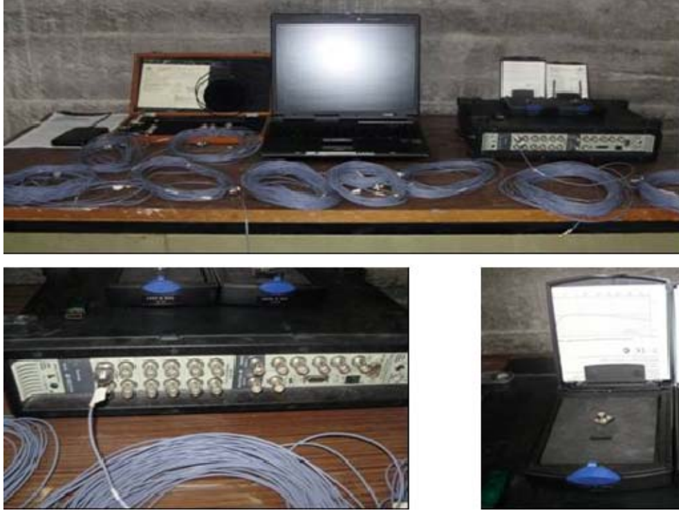
Şekil 43. Tip-1 kemer barajının çevresel titreşim testlerinde kullanılan ölçüm sistemi
