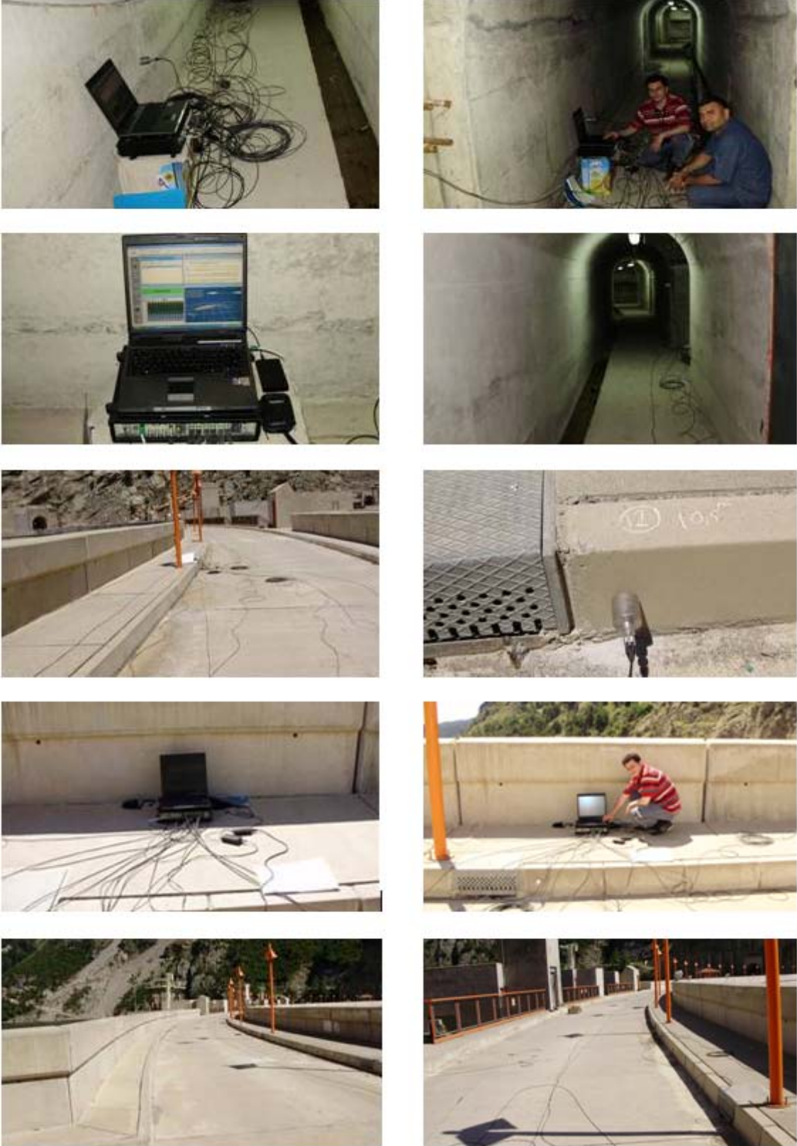
Şekil 124. Berke Barajı'nda gerçekleştirilen çevresel titreşim testlerine ait bazı fotoğraflar
