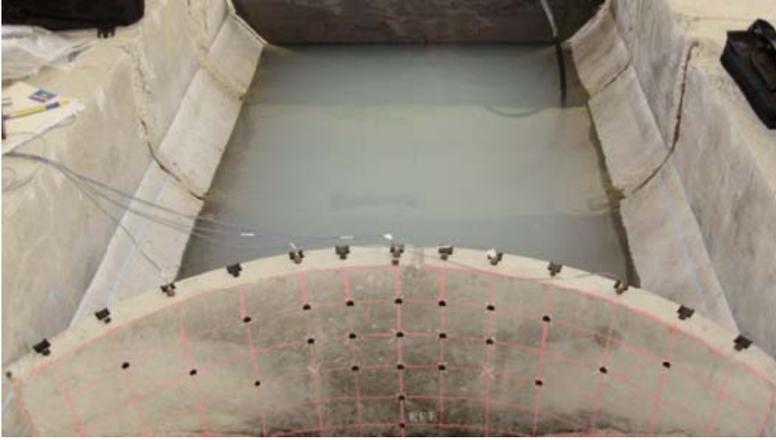
Şekil 86. Tip-1 kemer barajında H_3 durumu için gerçekleştirilen zorlanmış titreşim testi
