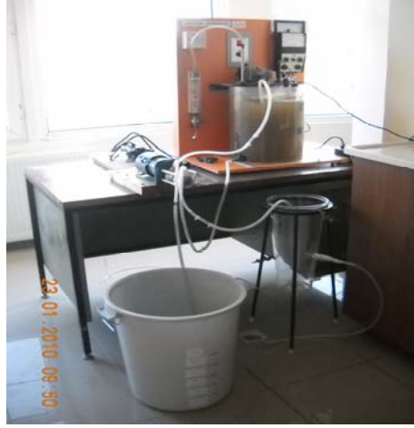
Şekil 9. Laboratuvar ölçekli klasik aktif çamur sistemi görünüşü
