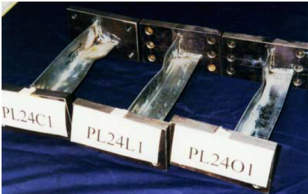
Şekil 1.4. Lokal burkulma modunda göçen korniyerler
