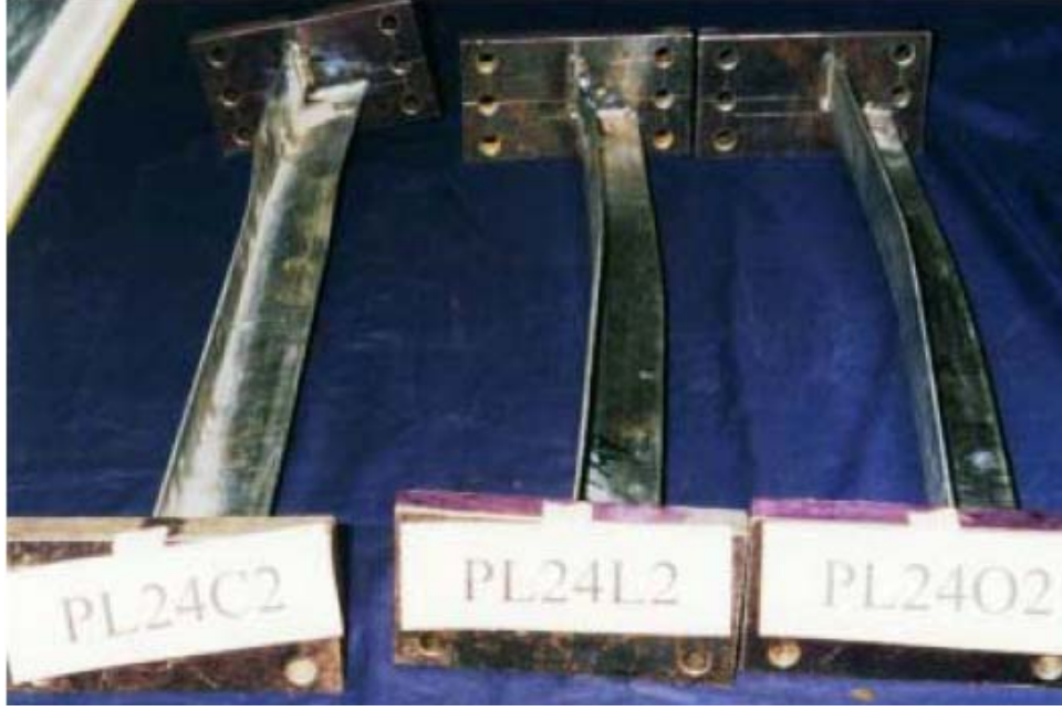
Şekil 1.3. Burulmalı-eğilmeli ve eğilmeli burkulma modunda göçen korniyerler
