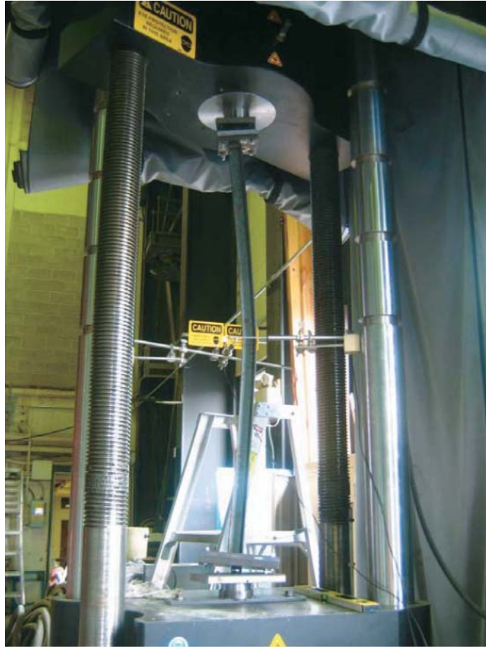
Şekil 2.12. Aksenal basınç yükü altında test edilen uç mafsallı korniyerlere ait deney düzeneği. (Liu ve Hui, 2010)
