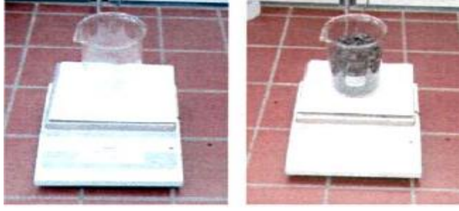
Şekil 29. SMA karışımının hazırlanması ve cam beherin boş ve karışım dolu tartımı
