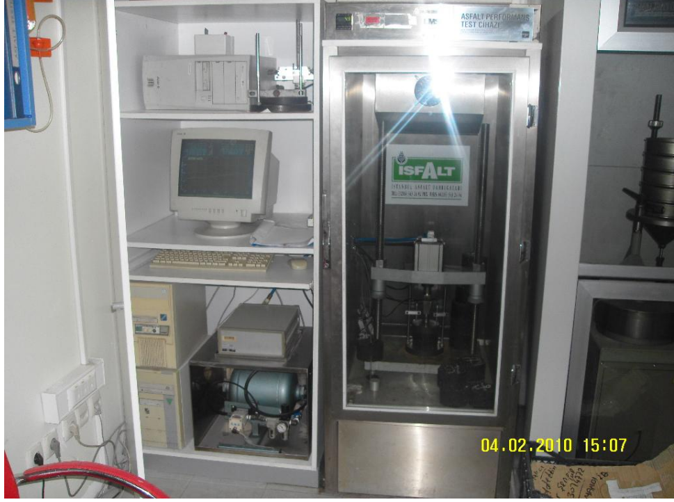
Şekil 35. Sünme deneylerinin yapıldığı cihaz ile test düzeneği
