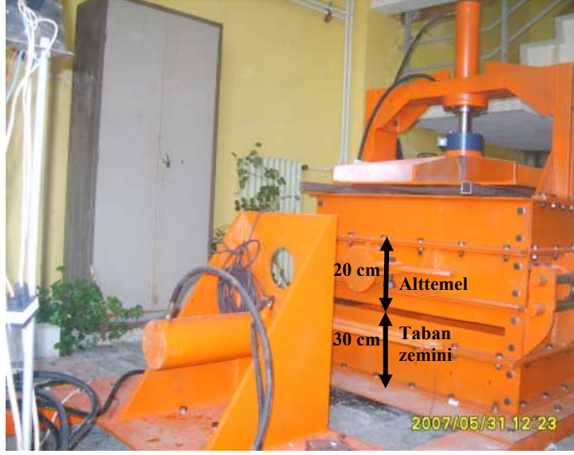
Şekil 32. (a) Pullout test kutusunda serilen alttemel ve taban zemini malzemenin kalınlıkları
