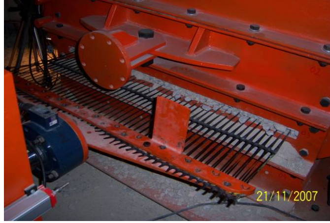
Şekil 34. Deney esnasında sıkıştırılmış malzeme arasındaki geogride çekme kuvveti uygulanması
