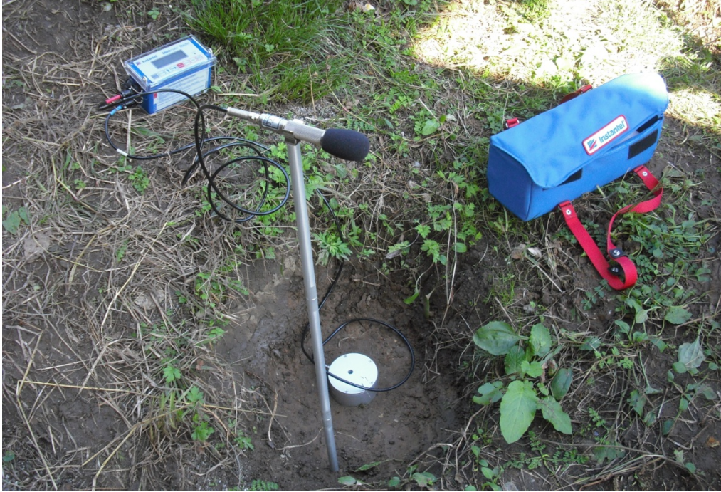
Şekil 2.4. Ölçüm seti ile zemin titreşimleri ve hava şokunun ölçülmesi
