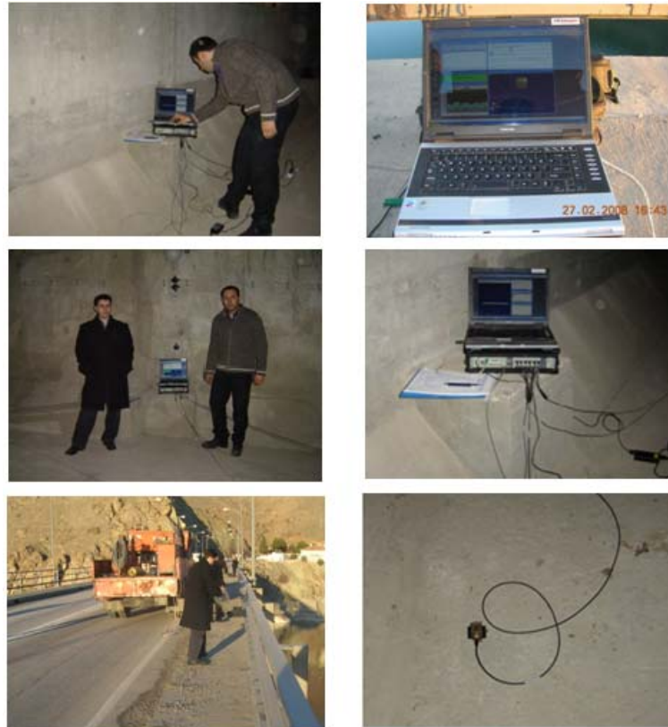
Şekil 2.46. Kömürhan Köprüsü'nde gerçekleştirilen çevresel titreşim testlerine ait bazı fotoğraflar
