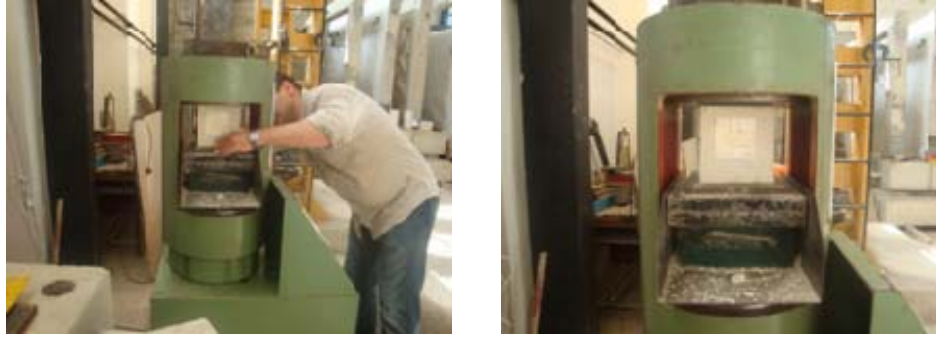
Şekil 2.11. Küp numunelerin tek eksenli basınç deneylerinden bazı fotoğraflar
