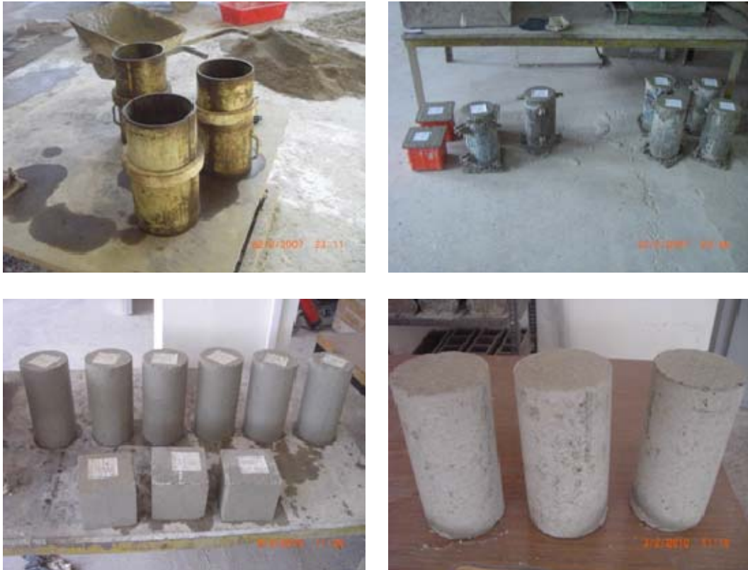
Şekil 2.10. Silindir ve küp numunelerin alınmasına ve hazırlanmasına ilişkin bazı fotoğraflar
