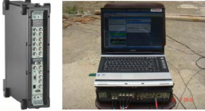
Şekil 1.6. B&K 3560 C tipi 17 kanallı veri toplama ünitesi
