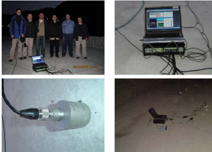
Şekil 2.86. Gülburnu Köprüsü'nde gerçekleştirilen çevresel titreşim testlerine ait bazı fotoğraflar
