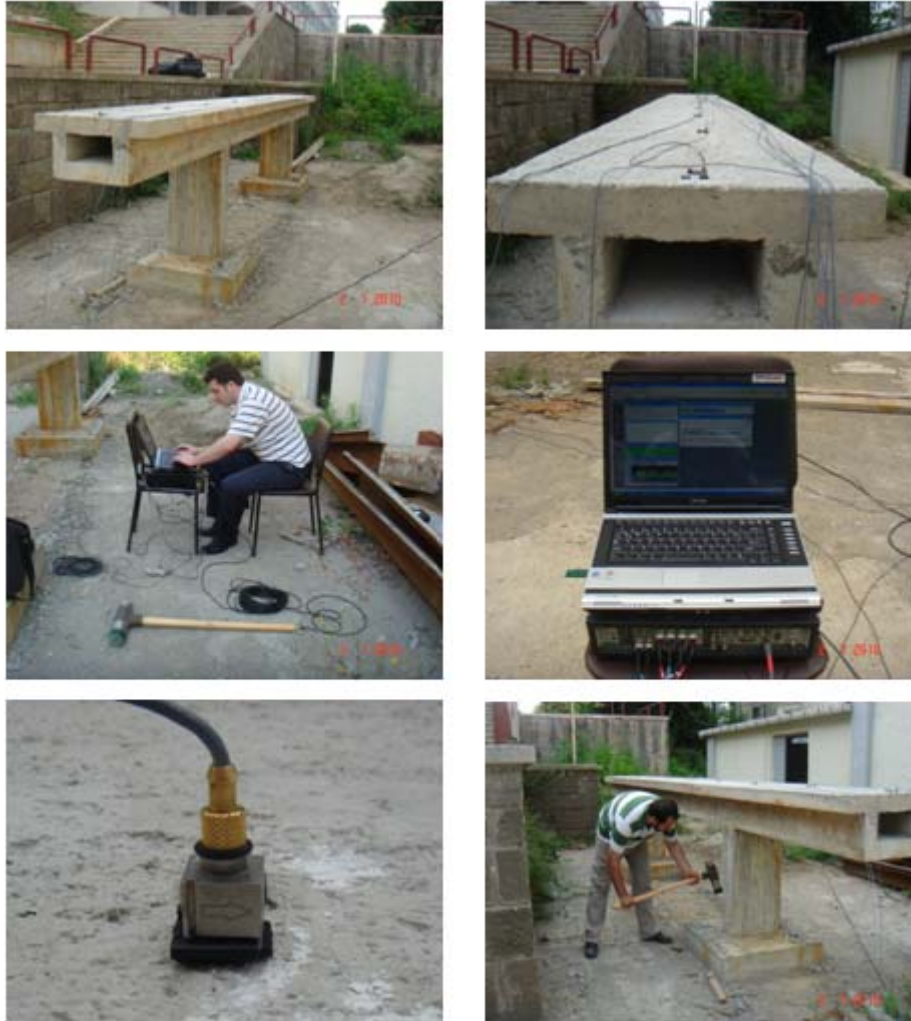
Şekil 2.17. Model köprüde gerçekleştirilen çevresel titreşim testlerine ait bazı fotoğraflar
