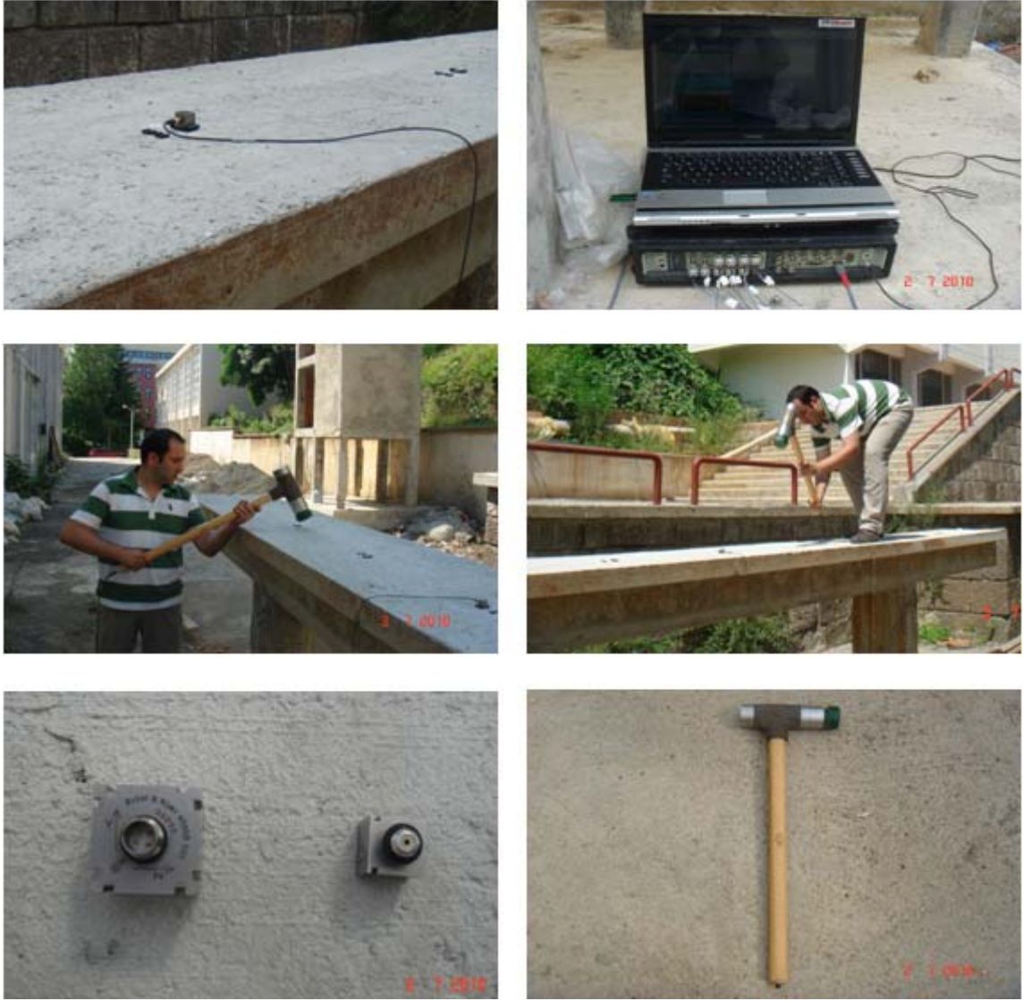
Şekil 2.26. Model köprü'nün zorlanmış titreşim testlerine ait bazı fotoğraflar
