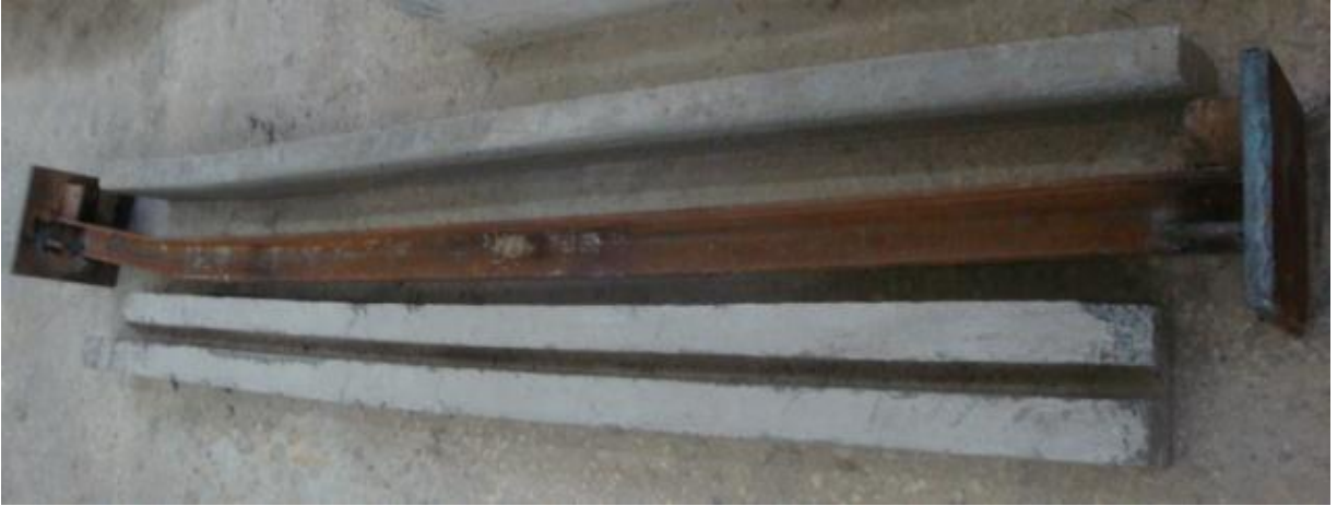
Şekil 3.16. 2L60×60×6 çaprazına ait olan betonarme prefabrike elemanların, şekildeğişimlerinin geri dönmesi
