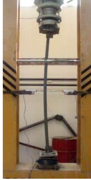
Şekil 3.4. U65 çaprazına ait burkulmaları sınırlandırılmamış deney öncesi ve deney sonrasında görünüm
