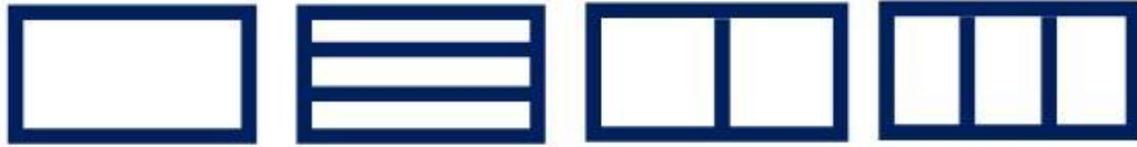
Şekil 3.47. HDPE ve PA malzemelerinden önerilen enkesitler
