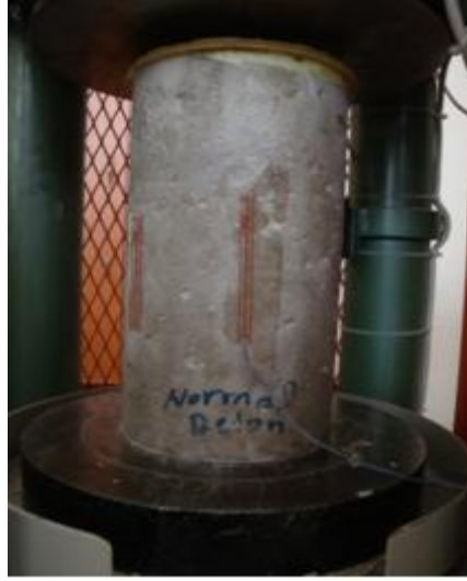
Şekil 2.12. Birim şekildeğiştirme ölçerleri (strain gauge) yapıştırılmış numune
