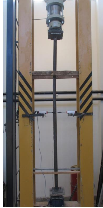
Şekil 3.5. 2L60×60×6 çaprazına ait burkulmaları sınırlandırılmamış deney öncesi ve deney sonrasında görünüm
