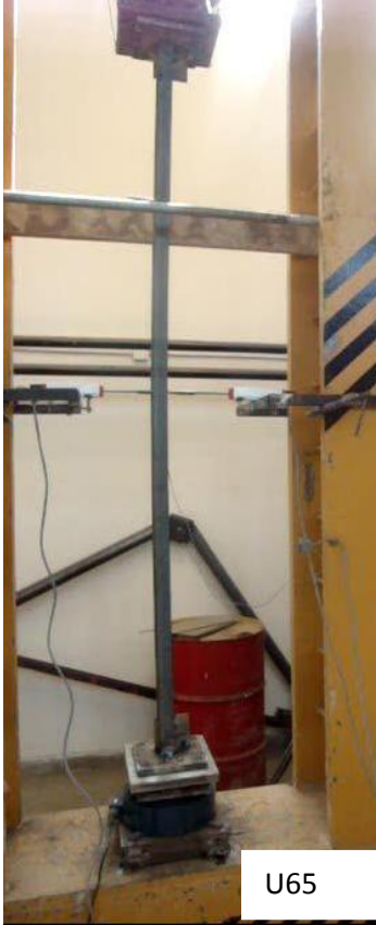
Şekil 2.21. Deneye hazır olan 2L60×60×6 ve U65 profillerinden oluşan çapraz numuneleri
