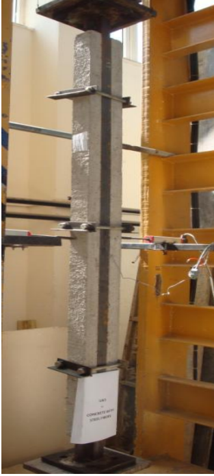
Şekil 3.20. U65 çaprazına ait burkulmaları çelik lifli betonla sınırlandırılmış deney öncesi ve deney sonrasında görünüm
