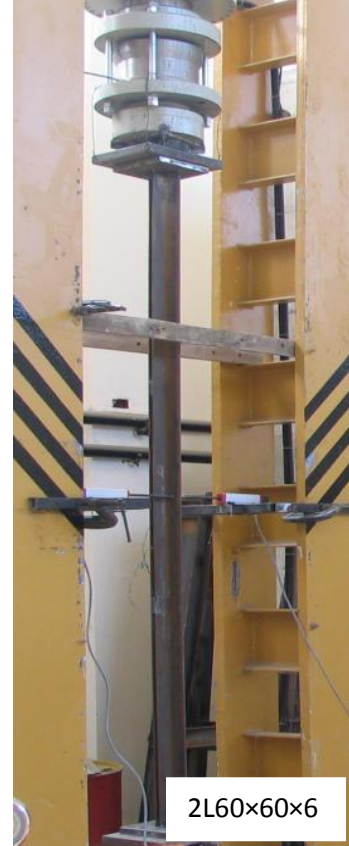
Şekil 2.21. Deneye hazır olan 2L60×60×6 ve U65 profillerinden oluşan çapraz numuneleri
