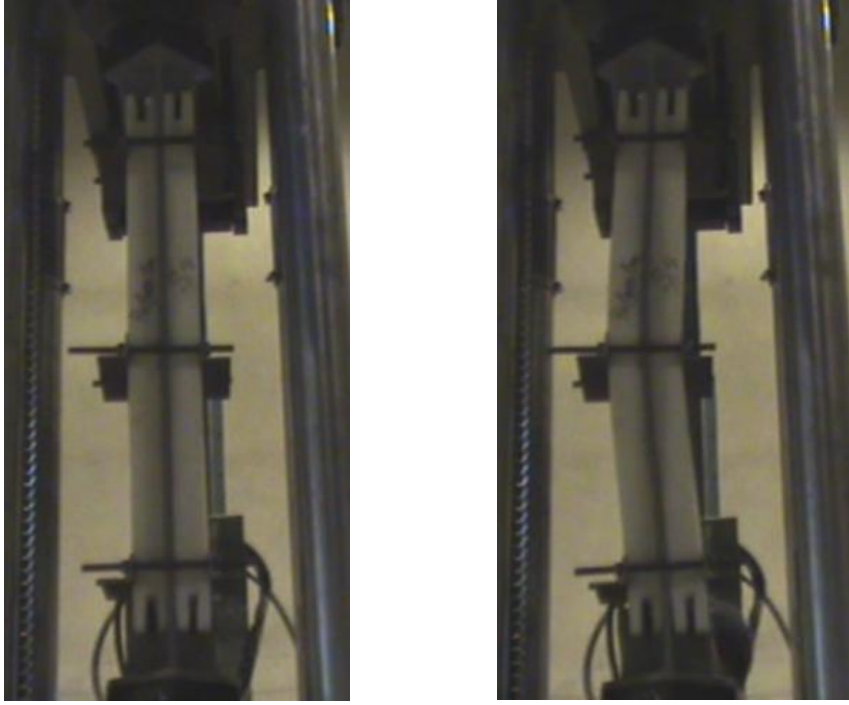
Şekil 3.41. 100×10 levha çaprazına ait burkulmaları HDPE levhalarla zayıf ekseninde sınırlandırılmış deney öncesi ve deney sonrasında görünüm
