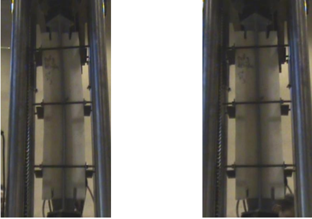
Şekil 3.44. 100×10 levha çaprazına ait burkulmaları HDPE levhalarla güçlü ekseninde sınırlandırılmış deney öncesi ve deney sonrasında görünüm
