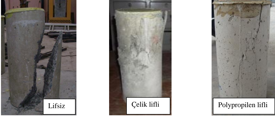
Şekil 2.14. Merkezi basınç deneyinde kırılan lifli ve lifsiz beton numuneler
