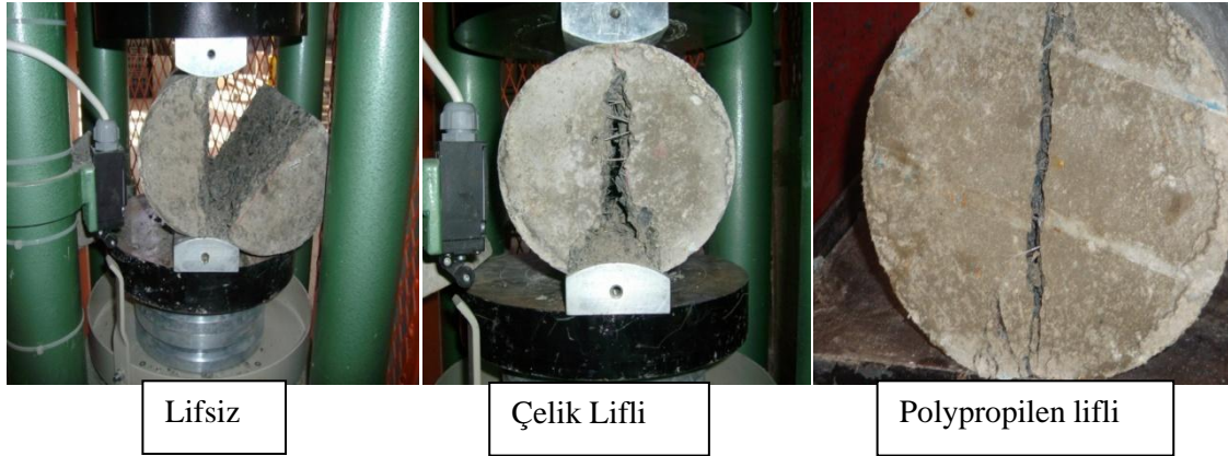
Şekil 2.16. Yarmada çekme deneyinde lifsiz, çelik lifli ve polypropilen lifli beton numunelerin kırılma şekli
