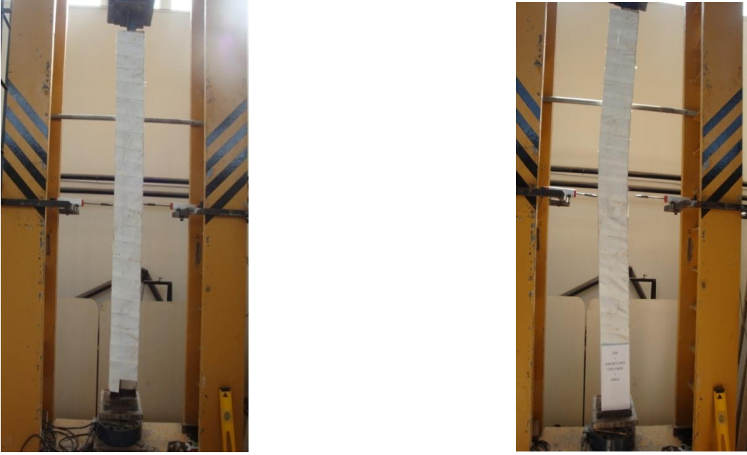
Şekil 3.24. 2L60×60×6 çaprazına ait burkulmaları lirefa sargılı çelik lifli betonla sınırlandırılmış deney öncesi ve deney sonrasında görünüm
