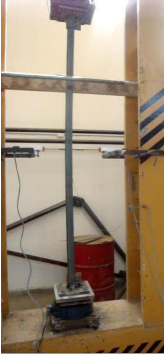
Şekil 3.4. U65 çaprazına ait burkulmaları sınırlandırılmamış deney öncesi ve deney sonrasında görünüm
