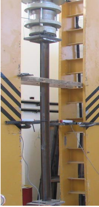
Şekil 3.5. 2L60×60×6 çaprazına ait burkulmaları sınırlandırılmamış deney öncesi ve deney sonrasında görünüm
