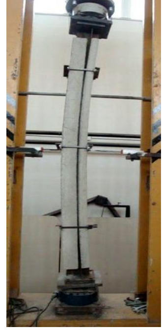
Şekil 3.19. 2L60×60×6 çaprazına ait burkulmaları çelik lifli betonla sınırlandırılmış deney öncesi ve deney sonrasında görünüm
