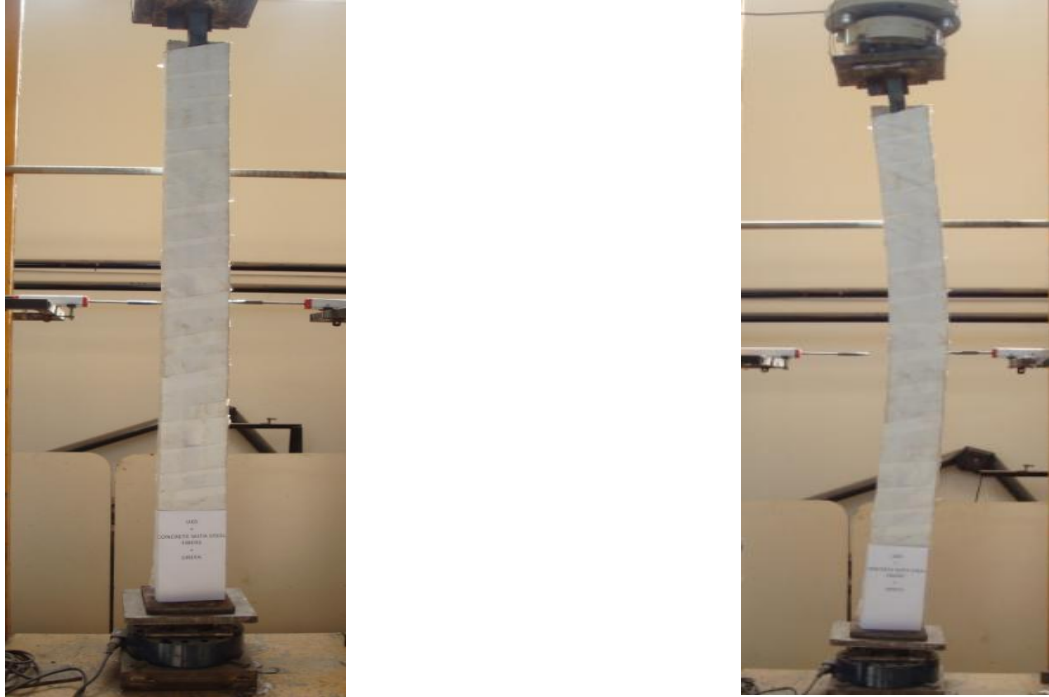
Şekil 3.25. U65 çaprazına ait burkulmaları lirefa sargılı çelik lifli betonla sınırlandırılmış deney öncesi ve deney sonrasında görünüm
