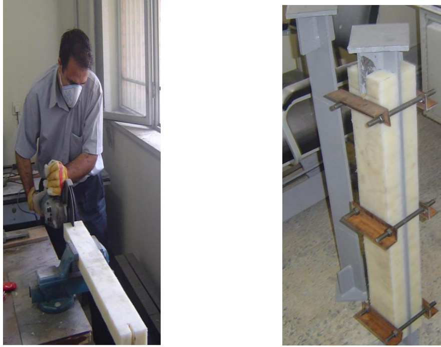
Şekil 2.20 Polyamid ve polyetilen levhaların hazırlanması
