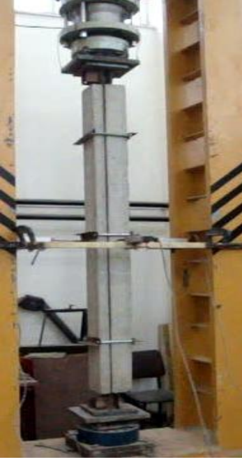
Şekil 3.12. Burkulması betonarme prefabrike elemanla sınırlandırılmış çaprazların deney öncesi ve deney sonrasında görünüm (2L60×60×6).
