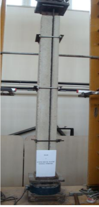
Şekil 3.19. 2L60×60×6 çaprazına ait burkulmaları çelik lifli betonla sınırlandırılmış deney öncesi ve deney sonrasında görünüm
