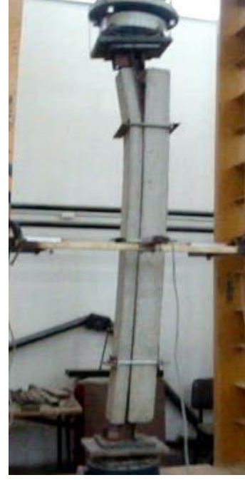
Şekil 3.12. Burkulması betonarme prefabrike elemanla sınırlandırılmış çaprazların deney öncesi ve deney sonrasında görünüm (2L60×60×6).
