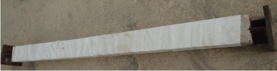
Şekil 2.30. Deneye hazırlanmış lirefa ile sarılmış çelik lifli prefabrike BRB numunesi
