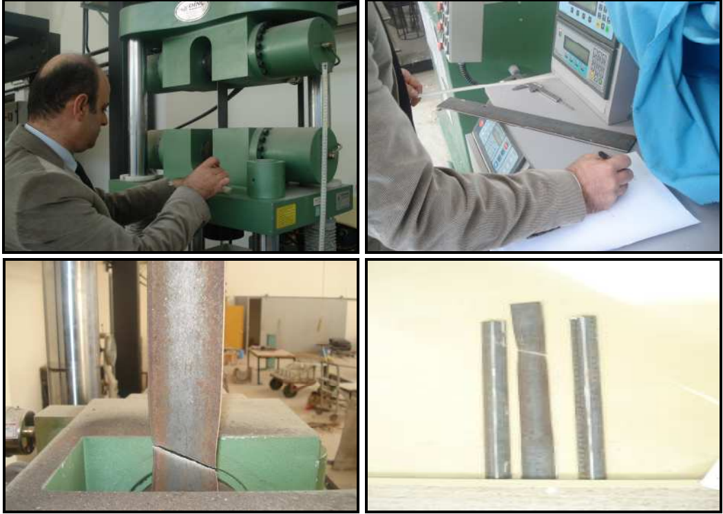
Şekil 26. Deneylerde kullanılan I profillerinin mekanik özelliklerinin deneysel tayini için gövde parçasının merkezi çekme deney görüntüleri (Y-1)
