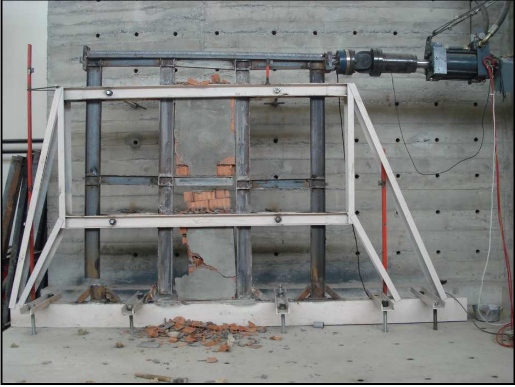
Şekil 84. Tuğla duvar dolgulu çerçeve sistemi deney numunesinin göçme durum
