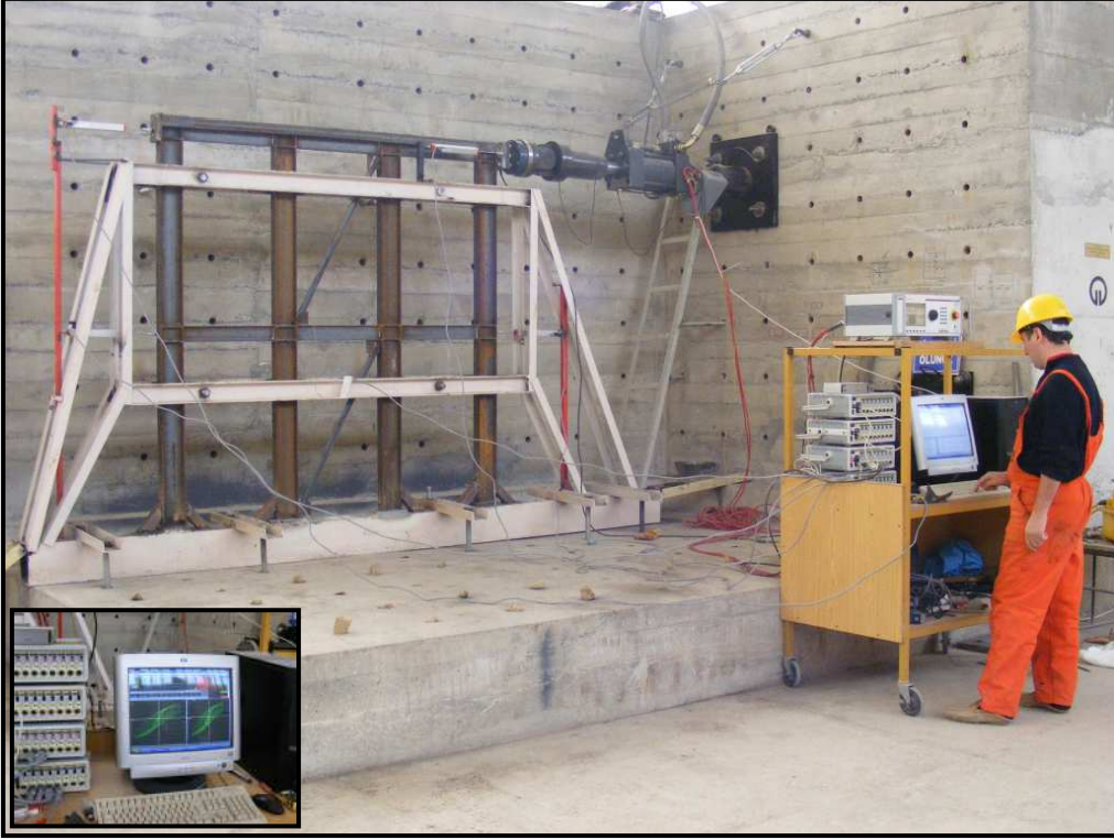
Şekil 113. N-7. Tek yönlü çelik köşegenli çerçeve sistemi için deney sonrası görünümü
