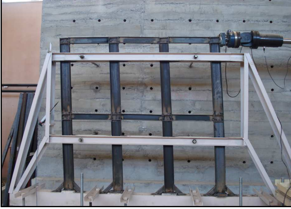
Şekil 41. Boş çelik çerçeve deney numunesinin çelik temel kirişine bağlanması
