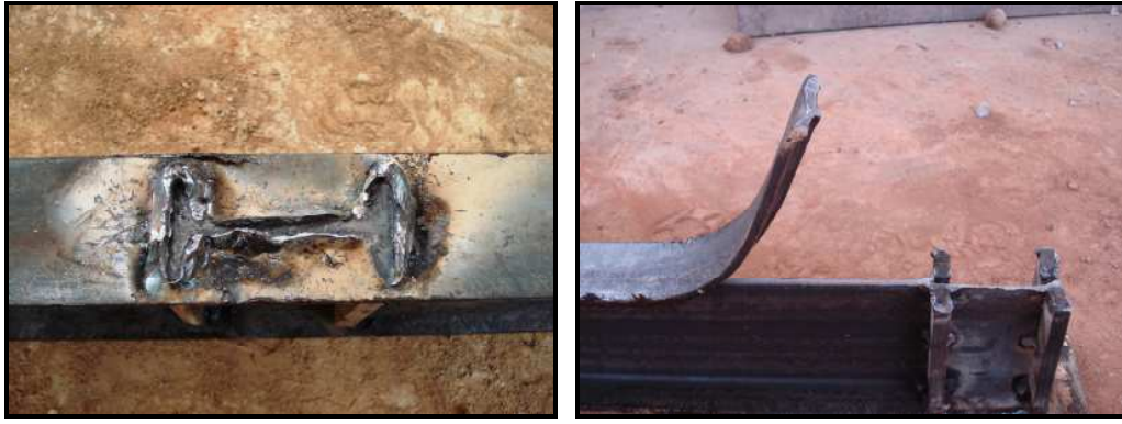
Şekil 72. Rutil kaynak kullanıldığı birleşimlerdeki kaynak kusurları
