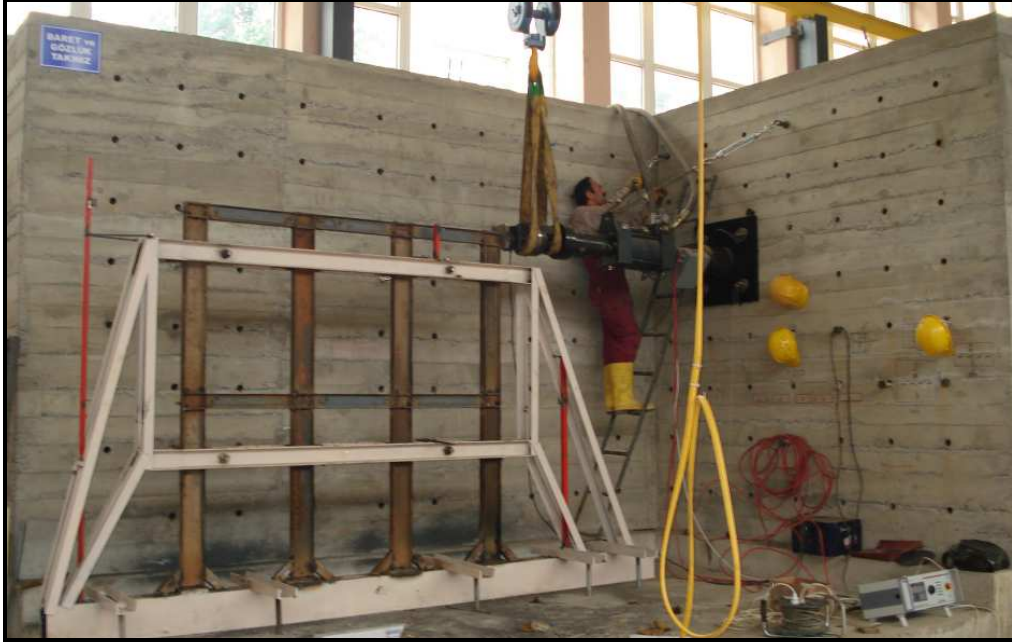
Şekil 74. N-1 Boş çerçeve deney numunesinin deney sonrası görünümü
