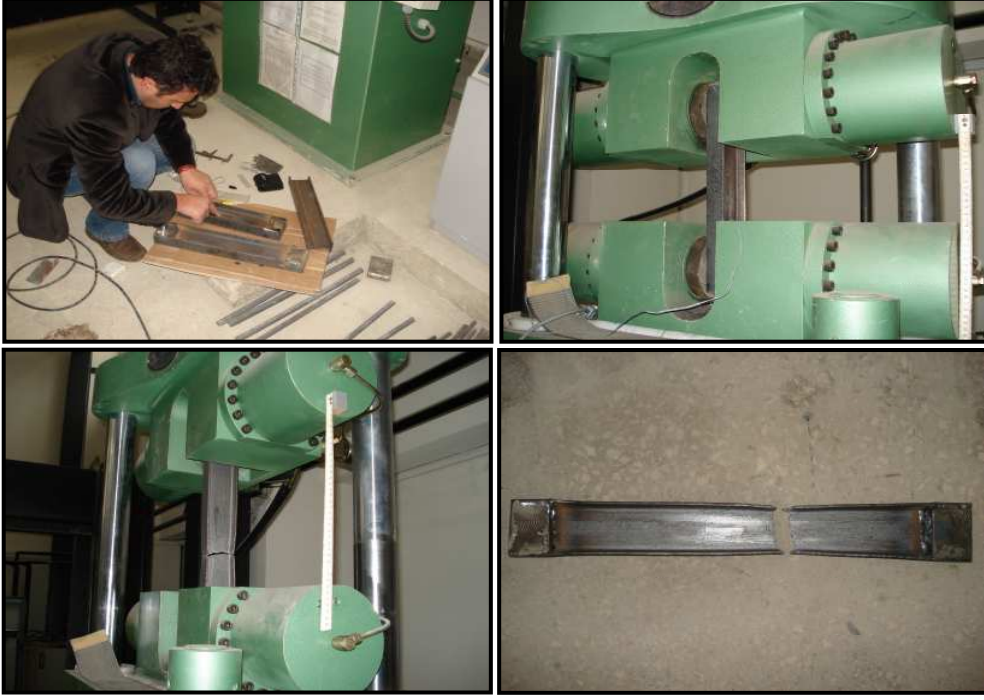
Şekil 27. Deneylerde kullanılan I profillerinin mekanik özelliklerinin belirlenmesi için yapılan merkezi çekme deneyi (Y-2)
