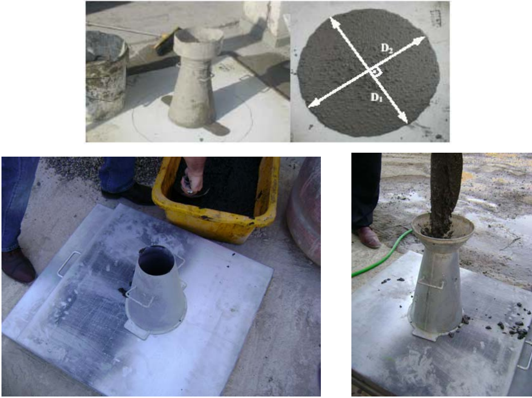
Şekil 29. Çökme yayılma deneyi
