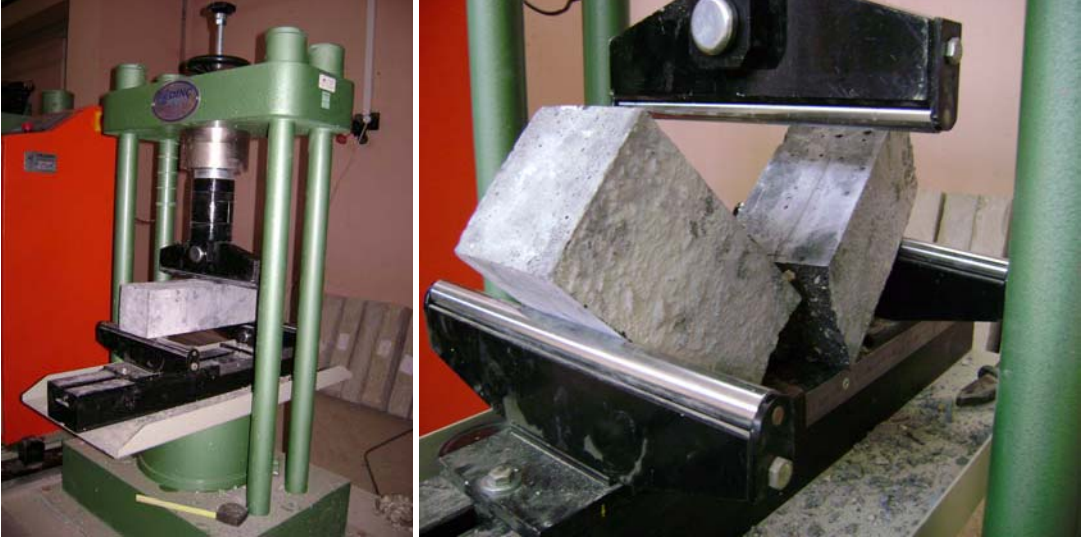
Şekil 37. Eğilmede çekme dayanımı deneyi
