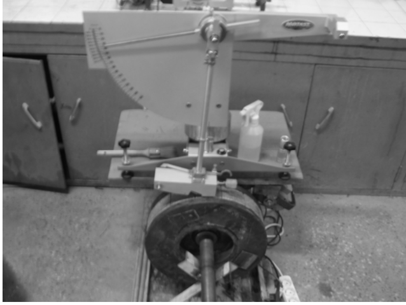
Şekil 41. Numunelerden sürtünme katsayısı ölçümü alınması
