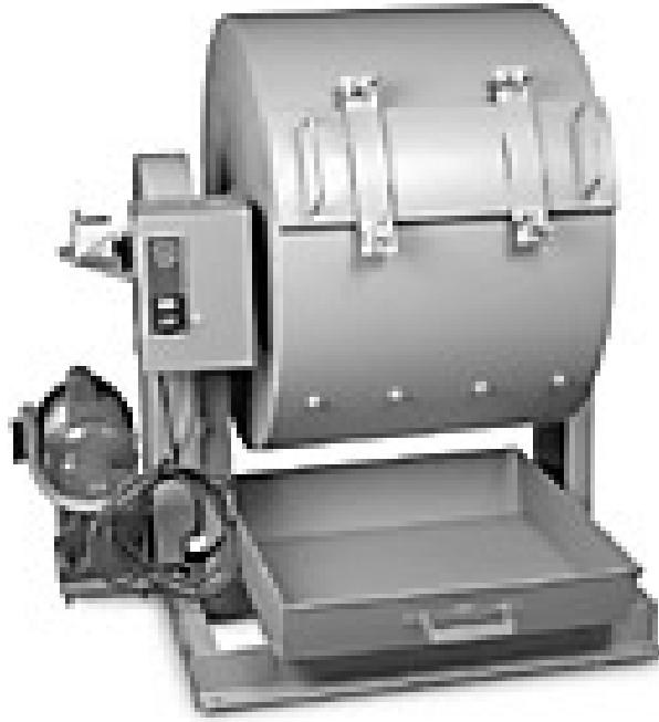
Şekil 8. Los Angeles aşınma test aleti
