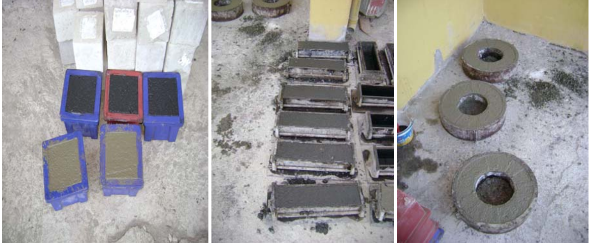
Şekil 31. Betonun kalıplara yerleştirilmesi
