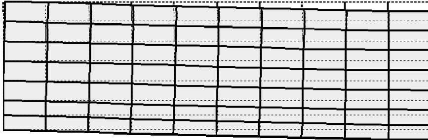
Şekil 3.14. Bresler/Scordelis kirişinin yerdeğiştirmiş durumu
