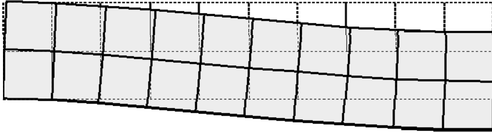
Şekil 3.42. T2LA kirişinin yerdeğiştirmiş durumu
