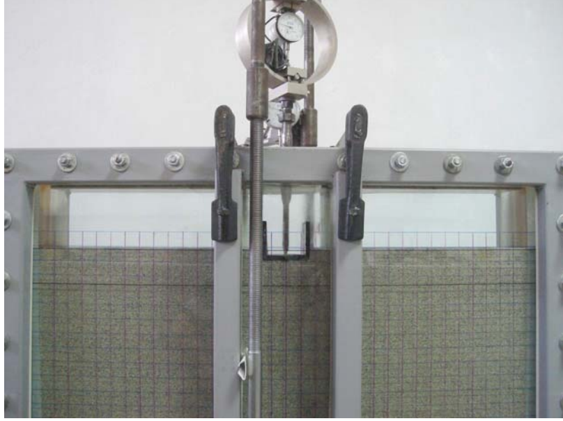
Şekil 2.7. Merkezi yüklü model sıg şerit temelle donatısız zeminde yapılan bir deneyde yüklemenin başlangıç hali
