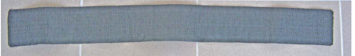
Şekil 2.4. Deneylerde kullanılan 0.90 m x 0.10 m boyutlarında kesilmiş örgülü geotekstil
