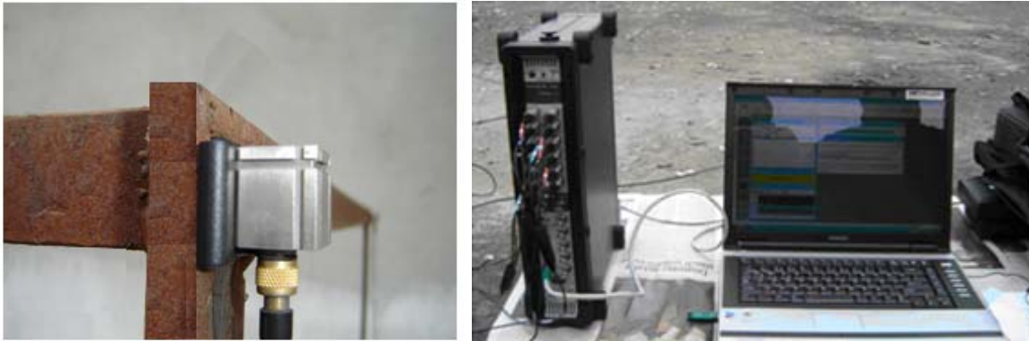
Şekil 2.3. Deneyde kullanılan üç eksenli ivmeölçer ile veri toplama ünitesi ve kayıt bilgisayarı
