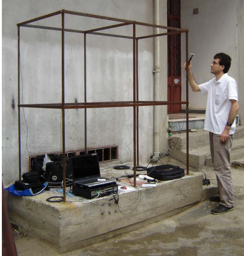
Şekil 2.4. Modelin darbe çekici ile titreştirilmesi
