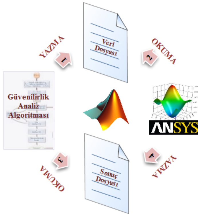
Şekil 41. Direkt birleştirme yöntemi
