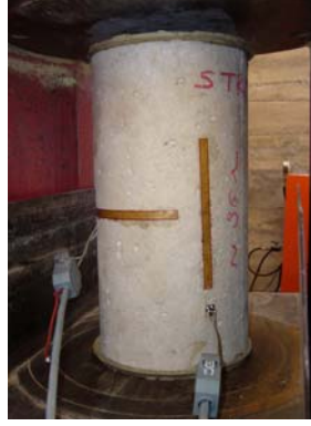
Şekil 35. Eksenel basınç deneyine tabi tutulan silindirlere birisi
