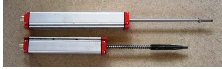
Şekil 60. Sehim ölçümünde kullanılan LPDT'ler
