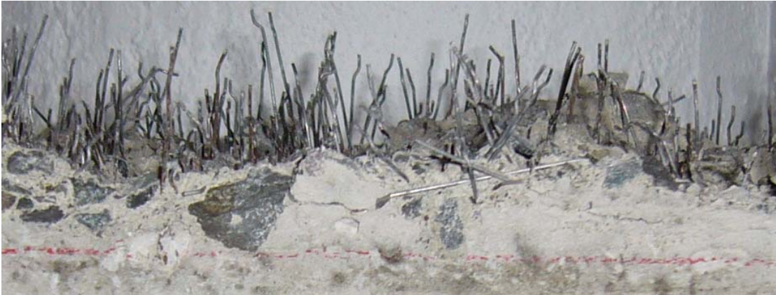
Şekil 2. Yarma deneyine tabi tutulmuş bir lifli silindir beton numunedeki görünüm
