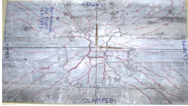
Şekil 73. AD4 döşemesine ait plastik mafsalları çizgileri
