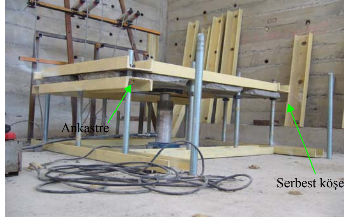
Şekil 160. K serisi döşemelerde basit mesnetli kenarlarda yer alan ankastre ve serbest köşeler
