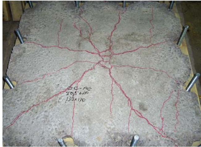
Şekil 131. AGLB4'e ait göçme mekanizması
