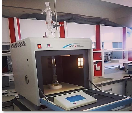
Şekil 22. Normal basınç reaktörü (atmosferik basınç altında sıcaklık kontrollü geri soğutucu altında ısıtma sistemi)
