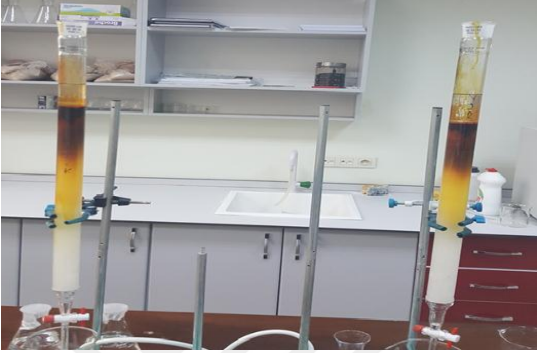
Şekil 6. Katalizörlü ve katalizörsüz piroliz işlemlerinden elde edilen sıvılara uygulanan kolon kromatografisi işleminin görünümü
