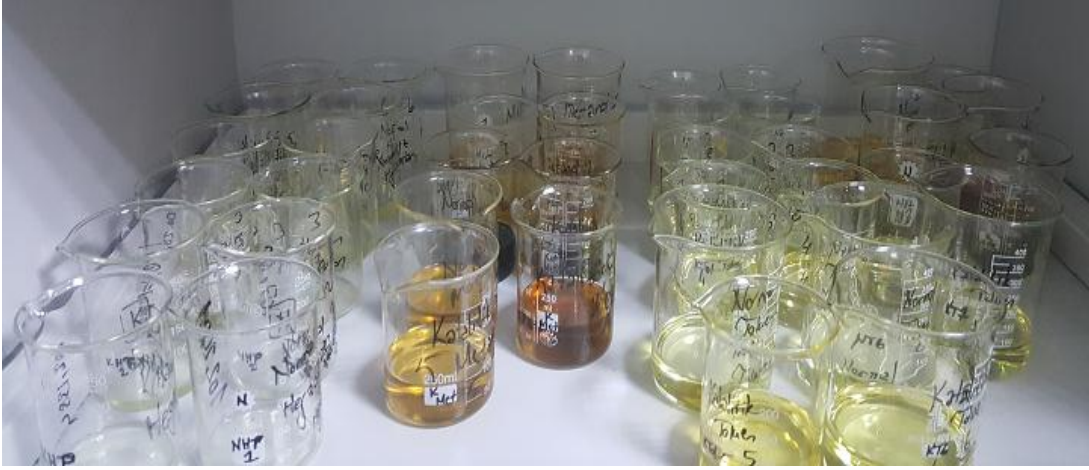
Şekil 7. Kolon kromatografisi ile dört ayrı fraksiyonda toplanmış pirolitik ürünlerin çözücülerini birlikte görünümü
