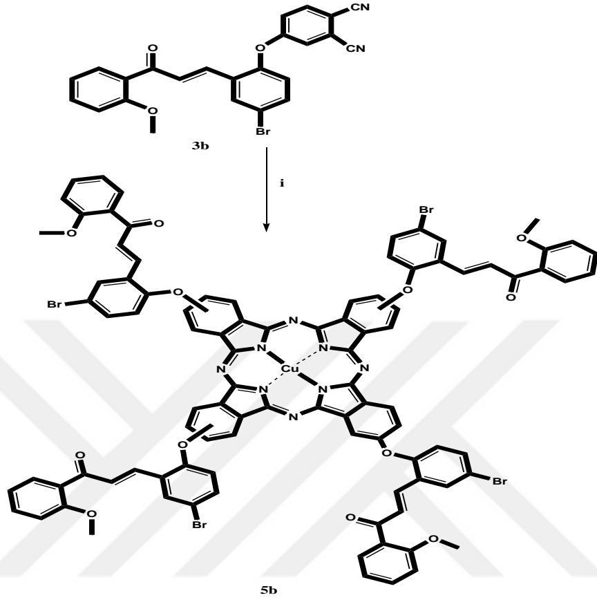
Şekil 73. 5b Nolu Cu(II)Pc bileşiğinin sentez şeması. (i) n-pentanol, DBU, 160 °C, CuCl 2 , N 2
