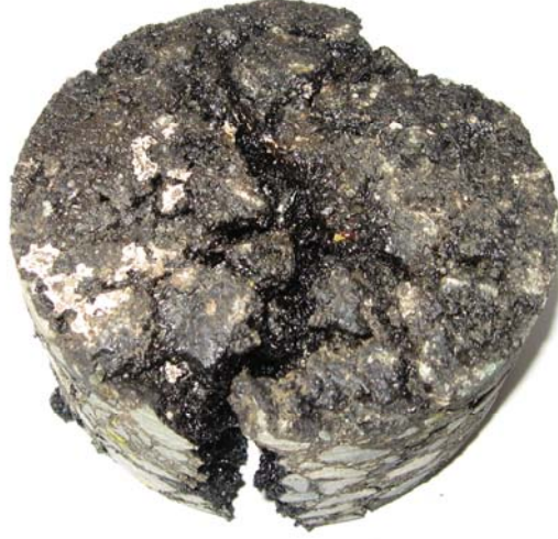
Şekil 46. Koşullandırma sırasında dağılan karot örneği
