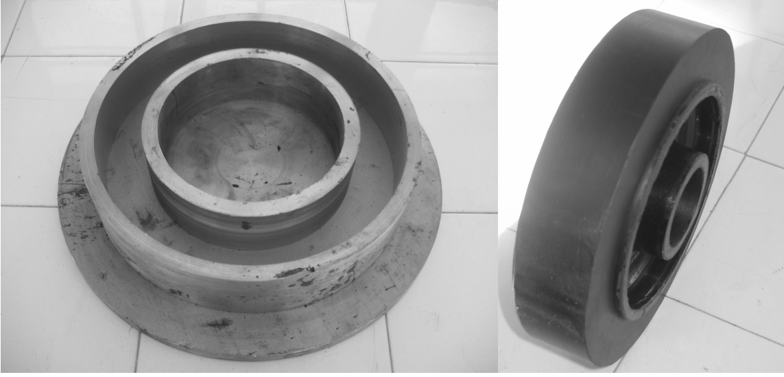
Şekil 2.13. Tekerleğin kauçuk kısmının yenilenmesi için yaptırılan kalıp ve yeni tekerlek
