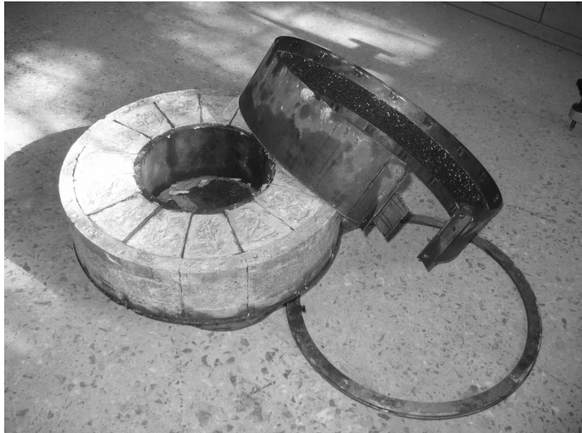
Şekil 2.5. İmal edilen kalıplar ve çıkan numuneler
