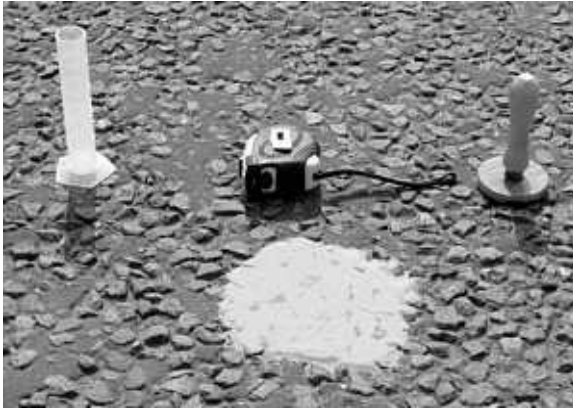
Şekil 1.12. Kum yama yönteminin uygulanışı
