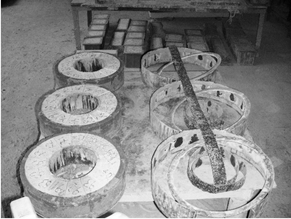
Şekil 2.19. Kalıplara yerleştirilen aşınma, basınç ve eğilmede çekme deney numuneleri
