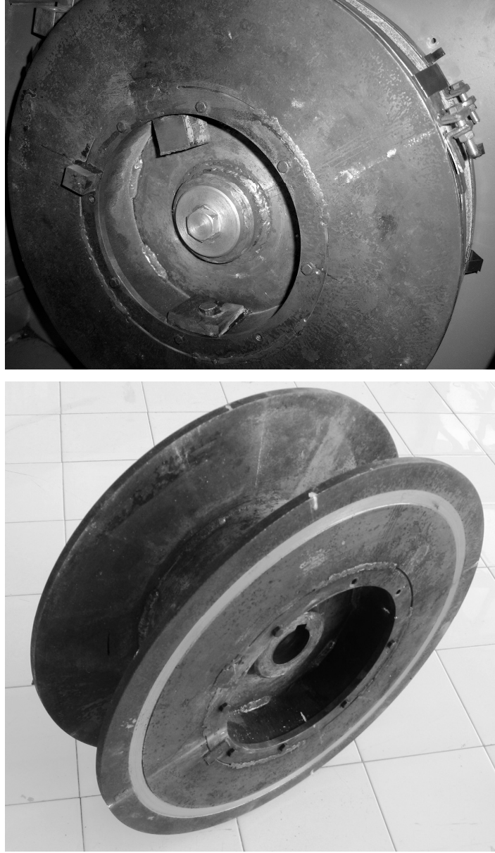
Şekil 2.4. Yeniden imal edilen derin yuvalı tambur
