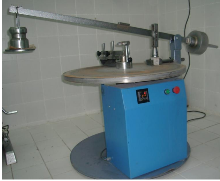
Şekil 28. Böhme yüzeysel aşınma cihazı
