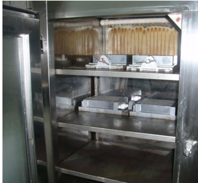
Şekil 25. Özel tasarlanmış nem dolabı
