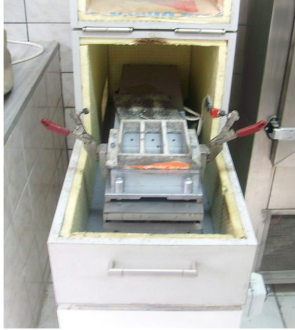
Şekil 22. Özel tasarlanmış sarsma cihazı (şok masası)
