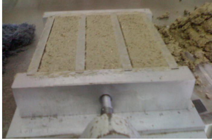
Şekil 24. Kalıpta üzeri düzeltilmiş harç numuneleri
