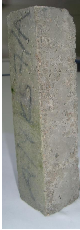
Şekil 40. Sülfat etkisinde bırakılmış, hava sürükleyici içeren CEM V/A (HSli, SO) çimentosundan üretilmiş harçta 360 gün sonunda meydana gelen yüzeysel soyulma
