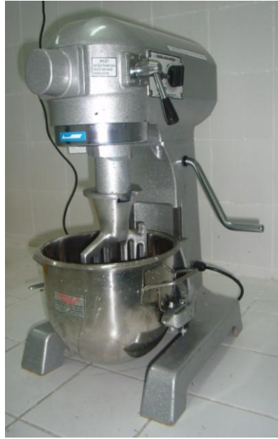
Şekil 21. Özel tasarım çimento harç karıştırıcısı
