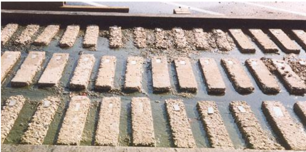
Şekil 3. Sülfatlı ortam etkisine maruz kalan beton kiriş örnekleri (URL-1, 2008).
