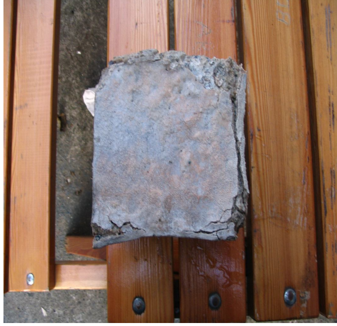
Şekil 14. 13 ay magnezyum sülfat çözeltisinde bekletilmiş mineral katkı içermeyen beton numune görüntüsü.
