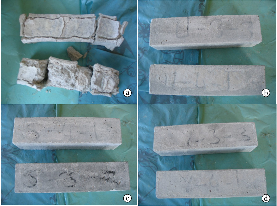
Şekil 20. 13 ay oda sıcaklığında magnezyum sülfat çözeltisinde bekletilmiş harç numune görüntüleri. (a) Mineral katkısız harç numuneler, (b) Uçucu kül katkılı harç numuneler, (c) Silis dumanı katkılı harç numuneler, (d) Yüksek fırın cürufu katkılı harç numuneler.
