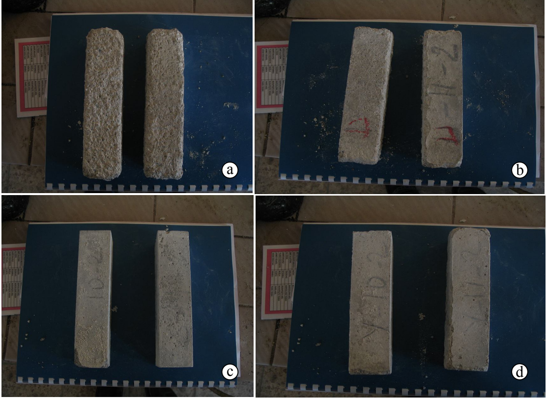
Şekil 18. 7 ay 5°C'deki magnezyum sülfat çözeltisinde bekletilmiş harç numune görüntüleri. (a) Mineral katkısız harç numuneler, (b) Uçucu kül katkılı harç numuneler, (c) Silis dumanı katkılı harç numuneler, (d) Yüksek fırın cürufu katkılı harç numuneler.
