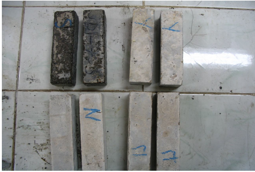
Şekil 24. 18 ay 40°C’de magnezyum sülfat çözeltisinde bekletilmiş harç numune görüntüleri
