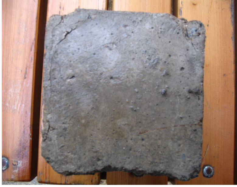
Şekil 12. 13 ay sodyum sülfat çözeltisinde bekletilmiş mineral katkı içermeyen beton numune görüntüsü.
