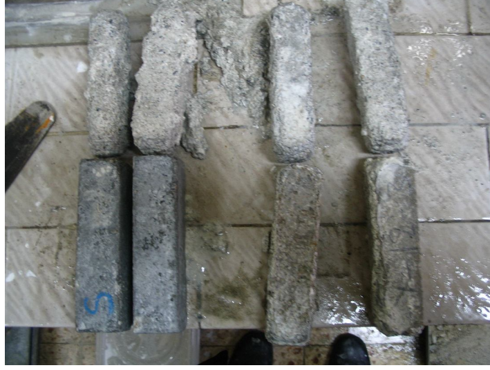
Şekil 25. 18 ay 5°C’de magnezyum sülfat çözeltisinde bekletilmiş harç numune görüntüleri
