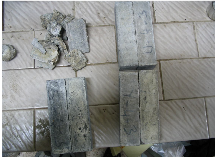
Şekil 23. 18 ay oda sıcaklığında magnezyum sülfat çözeltisinde bekletilmiş harç numuneler
