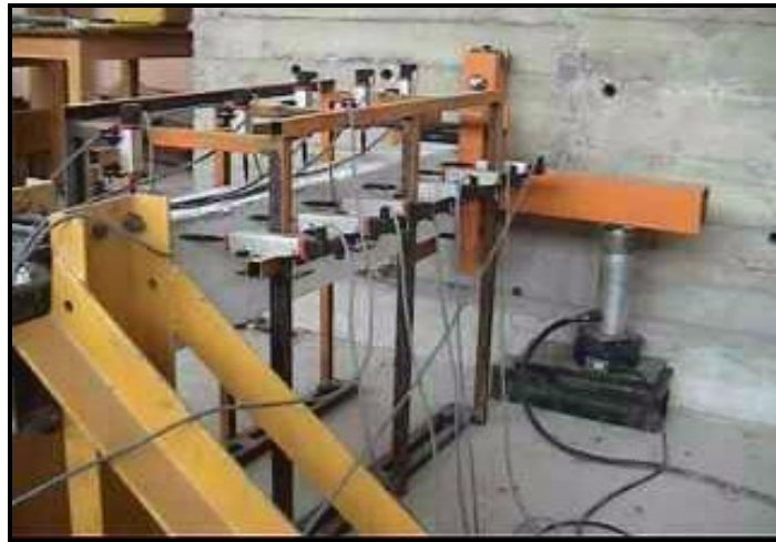
Şekil 31. Burulma deney düzeneği ve ölçüm çerçevesi
