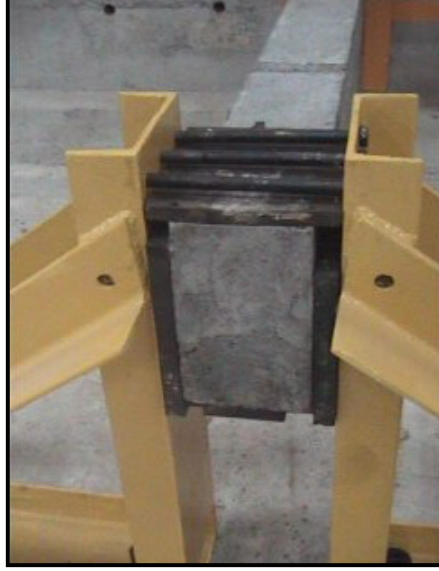
Şekil 28. Kirişin ankastre mesnede cıvatalar ve destek plakaları ile tespiti
