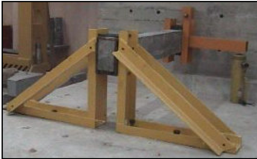
Şekil 27. Burulma deney düzeneginin mesnetleri
