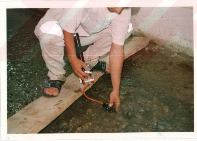
Ek Şekil 3.6 Konsantrasyon ölçümü için askı maddesinden nümune alınması
