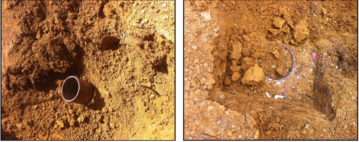
Şekil 2.23. Silindir ile bozulmamış toprak örneklerinin alınması
