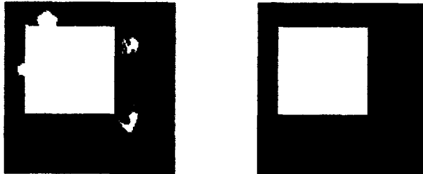
Şekil 12. Orijinal görüntü ve 15x15'lik yapı elementiyle açma işlemi sonucu
