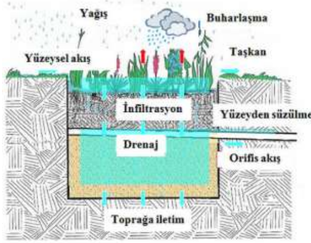
Şekil 5. Yağmur bahçelerinde tutulan suyun toprağa doğru sızması ve bitki solunumu yoluyla tekrar atmosfere dönmesi (Demir, 2012).
