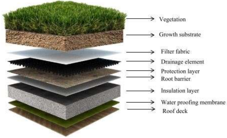
Şekil 15. Yeşil çatı sistemi kesiti (Vijayaraghavan, 2016)
