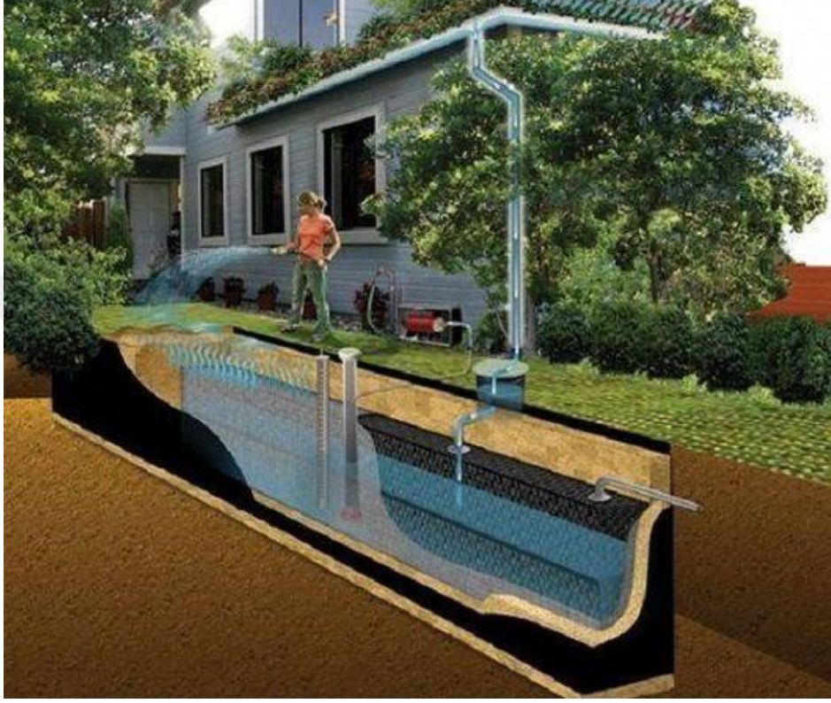
Şekil 20. Çatı Yağmur Suyu Toplama Sistem kesiti (URL-19)
