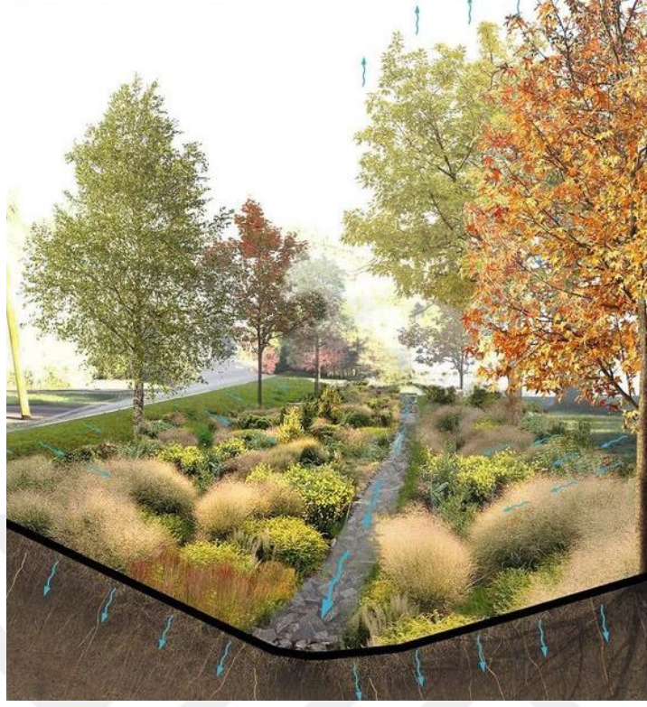
Şekil 11. Kentsel alanlarda peyzaj kanalı kesiti (URL-12)
