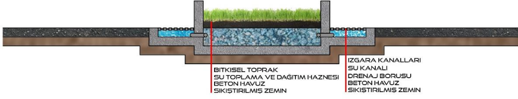
Şekil 38. Yapı Kesit Örneği
