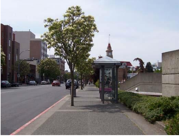
Şekil 6. Kesintisiz devam eden bölge: olası engeller (durak, ağaçlar)kaldırımın kenarlarına yerleştirilmiş durumda (URL-14).
