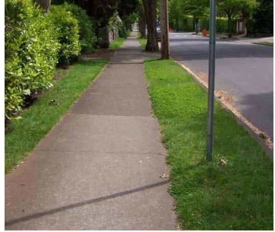
Şekil 6. Kesintisiz devam eden bölge: olası engeller (durak, ağaçlar)kaldırımın kenarlarına yerleştirilmiş durumda (URL-14).
