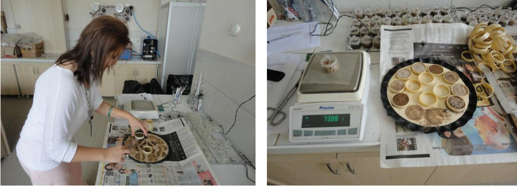
Şekil 58. K.T.Ü. Orman Fakültesi Toprak İlimi ve Ekoloji Laboratuvarında toprakların tarla kapasitesi, solma noktalarının tayini, 2011.
