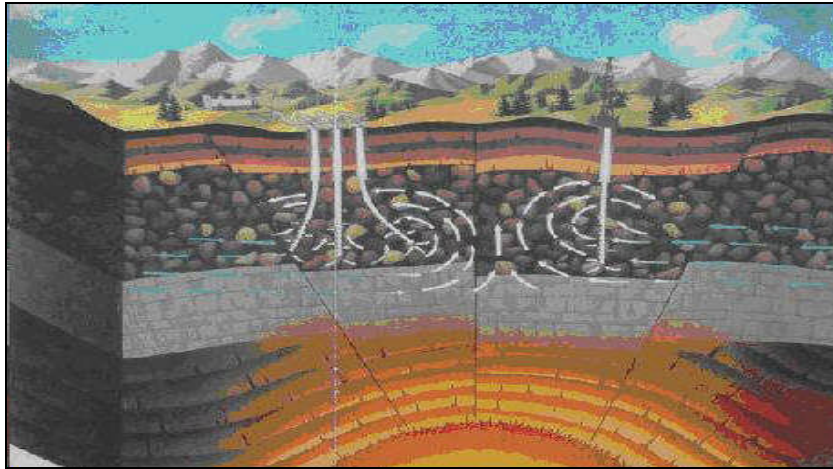
Şekil 2. Jeotermal sistemdeki rezervuar, üretim ve reenjeksiyon (URL 5).
