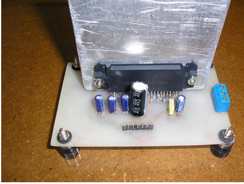
Şekil 61. Tümeleşik Güç Modülü ve CD40106 entegresinden oluşan sistem genel görünüşü
