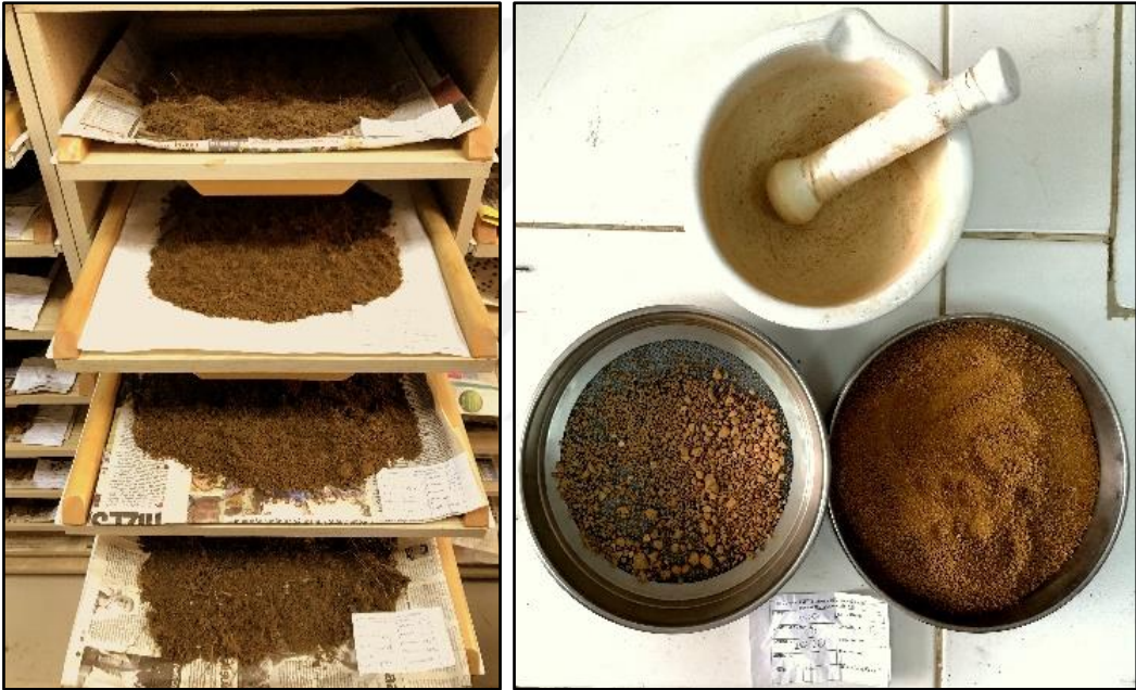
Şekil 13. Toprak örneklerinin hava kurusu hale getirilmesi ve öğütülerek elekten geçirilmesi
