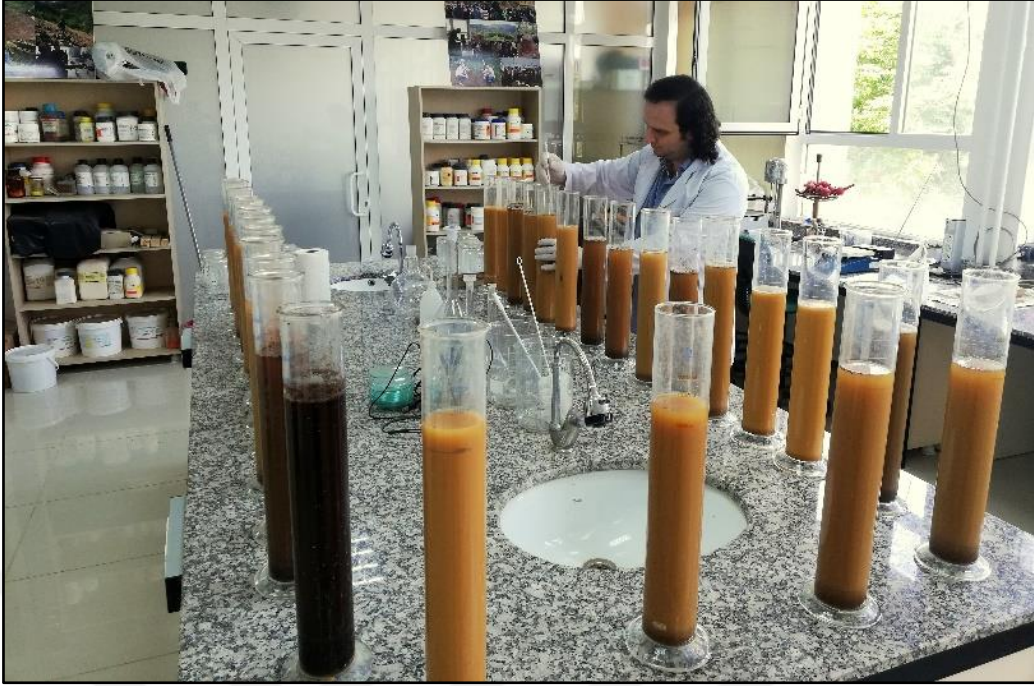
Şekil 14. Toprak örneklerinin tane boyutlarının belirlenmesi
