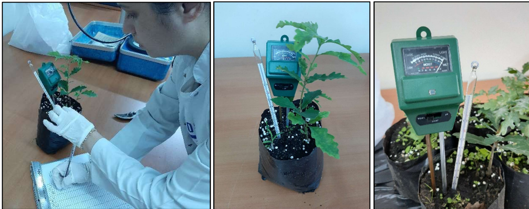
Şekil 10. Şafak öncesi ölçümlerde fidanlara ait toprak nem ve sıcaklıklarının ölçülmesi
