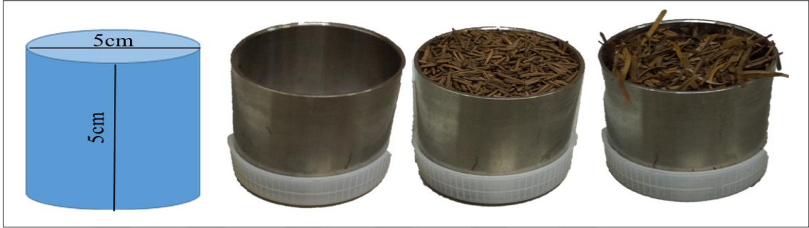
Şekil 91. Ladin ve Gökmar ibrelerinde hacim ağırlığı tespiti
