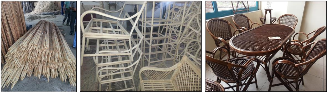
Şekil 5. Çubuk ve sırik üretimi ile bambu mobilya benzeri örme mobilya imalatı
