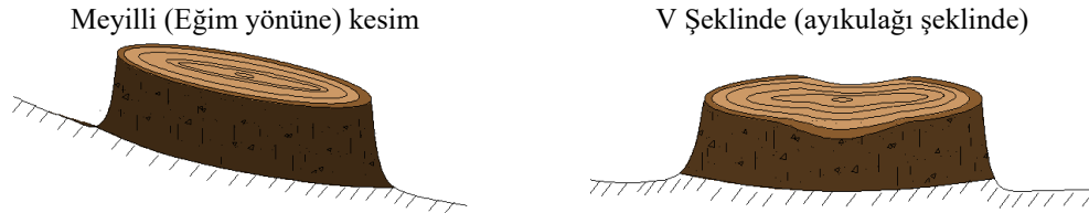
Şekil 14. Farklı kesim şekli işlemlerinin şekilsel gösterimi
