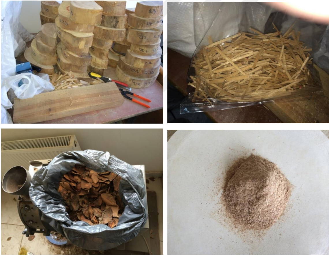
Şekil 18. Örnek ağaca ait gövde ve tüm ağaç bileşenlerinin parçalanması ve öğütmeye uygun hale getirilmesi
