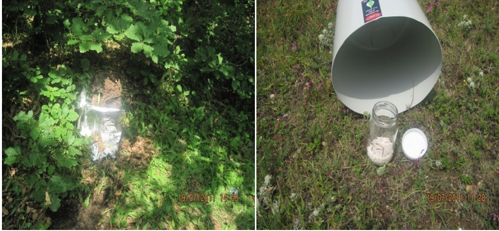
Şekil 10. Arazide toprak solunumu örnekleme yapılırken bir görünüm.
