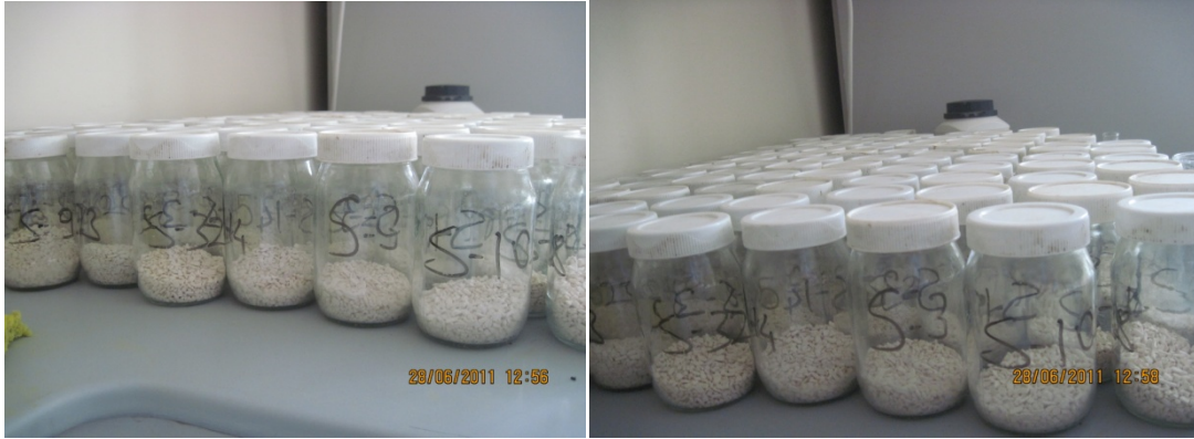
Şekil 7. Toprak solunumunda kullanılan cam kavanoz içinde soda kireç maddesi
