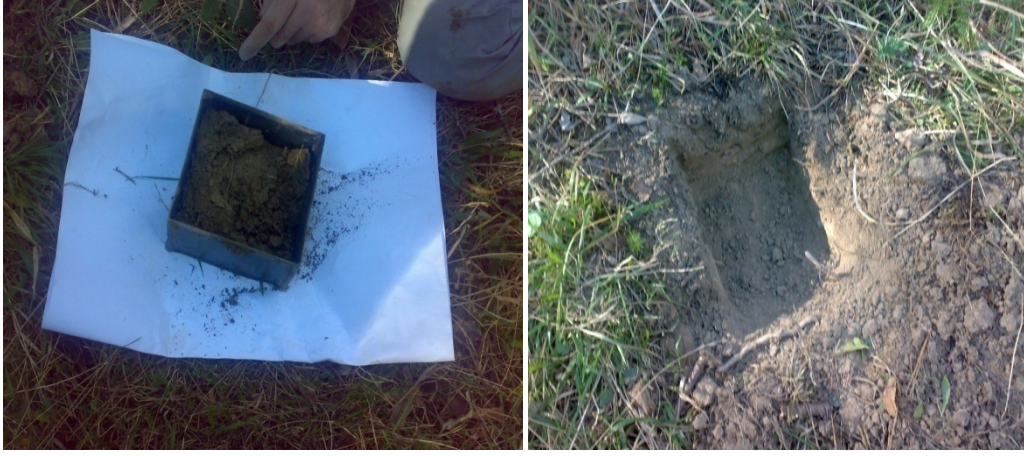
Şekil 11. Silindirden topraklar çıkarılırken bir görünüm
