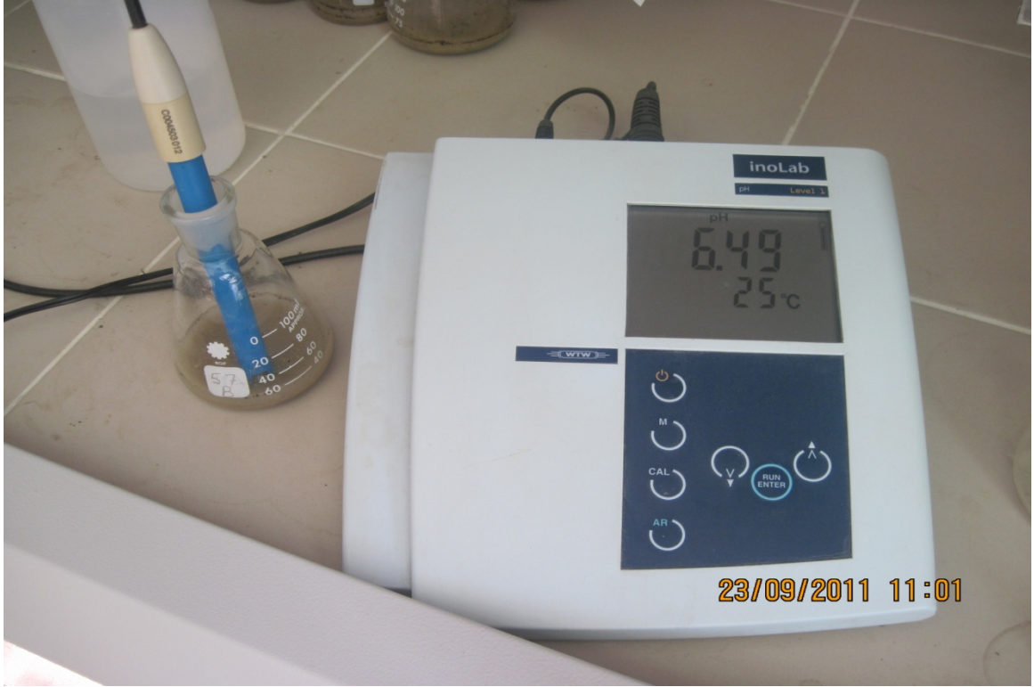
Şekil 9. Toprak örneklerinde pH ölçümü yapılırken bir görünüm
