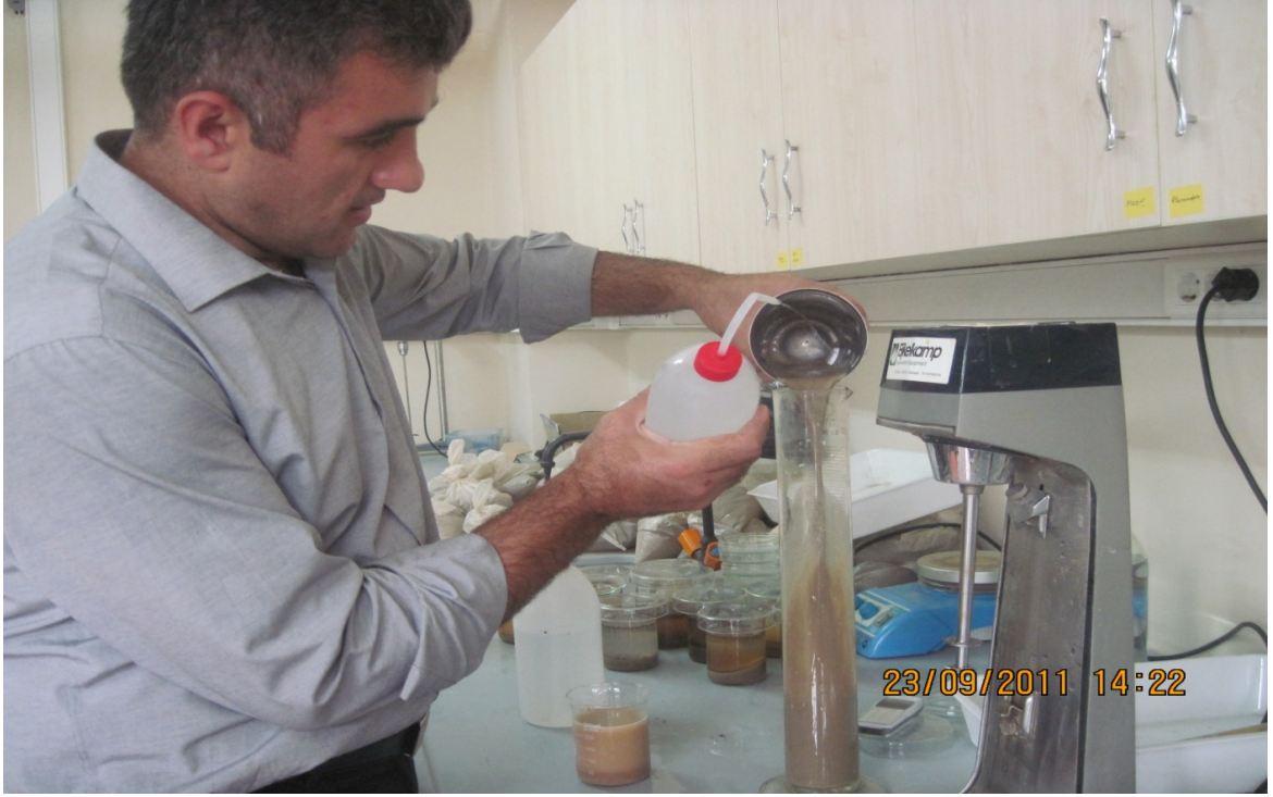
Şekil 8. Toprak örneklerinde mekanik analiz yapılırken bir görünüm
