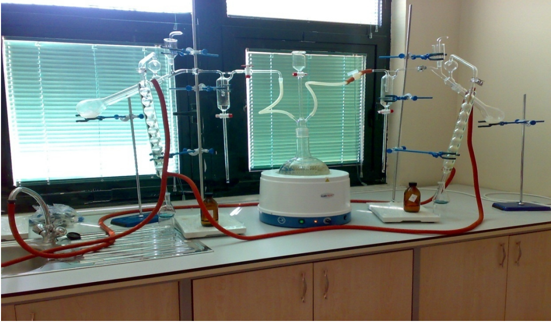
Şekil 14. Mikro Destilasyon cihazında toprak örneklerinin destilasyonu
