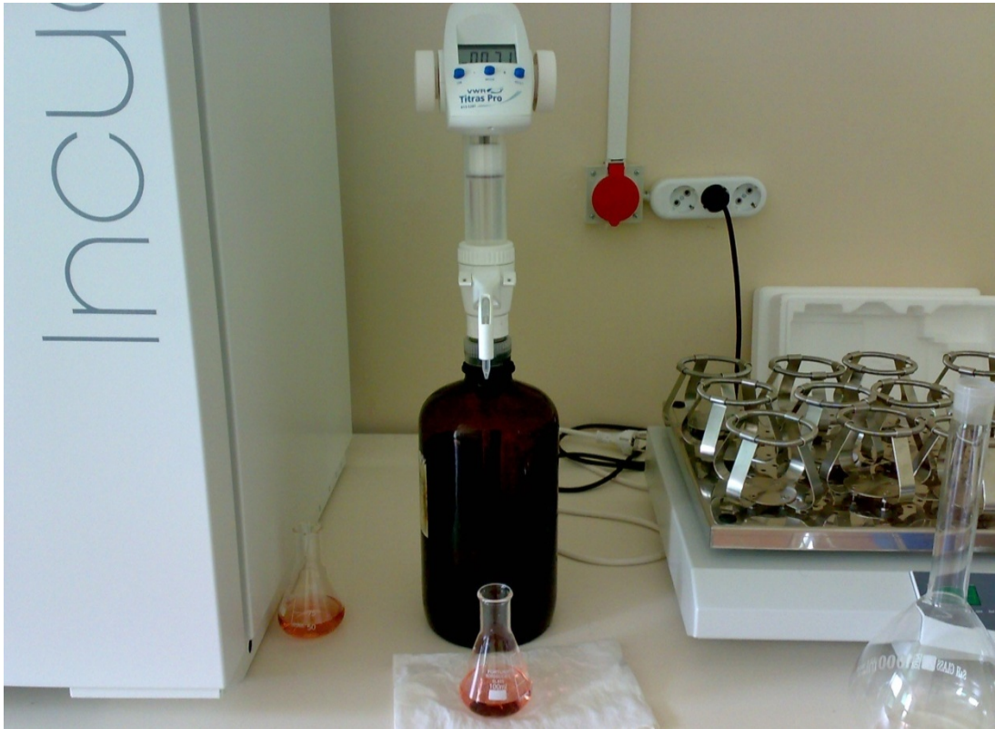
Şekil 15. Destile edilen örnekler üzerinde titrasyon yapılması
