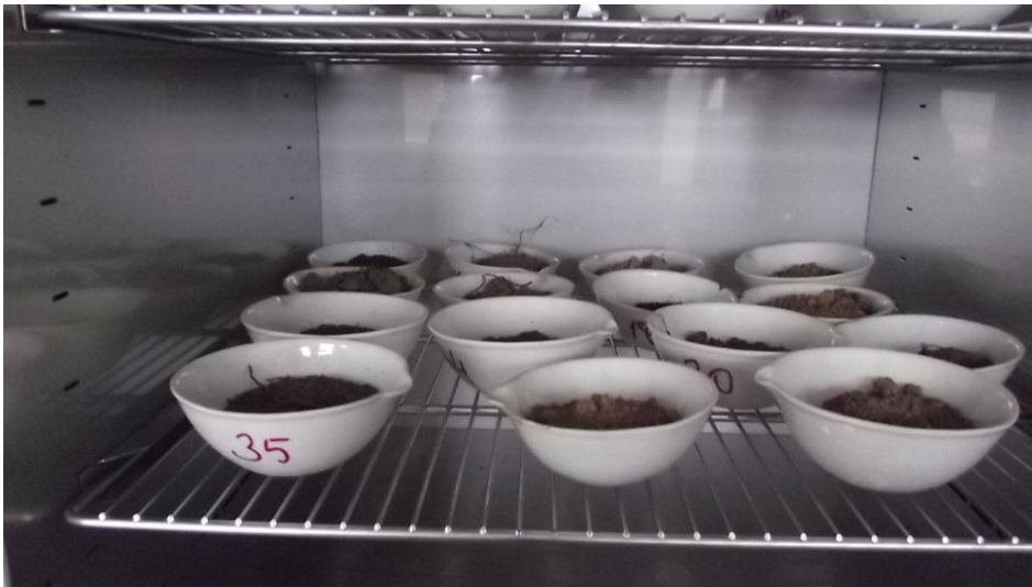
Şekil 19. Hacim ağırlığı silindir örneklerinin fırın kurusu hale getirilmesi
