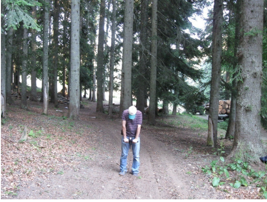
Şekil 15. Sürütme şeridinde el penetrometresiyle toprak sıkışıklığı ölçümü
