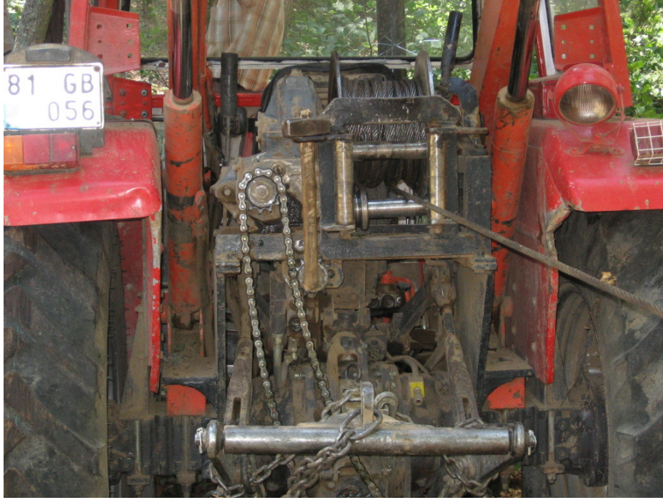
Şekil 10. Tarım traktörüne monte edilmiş kablolu vinç
