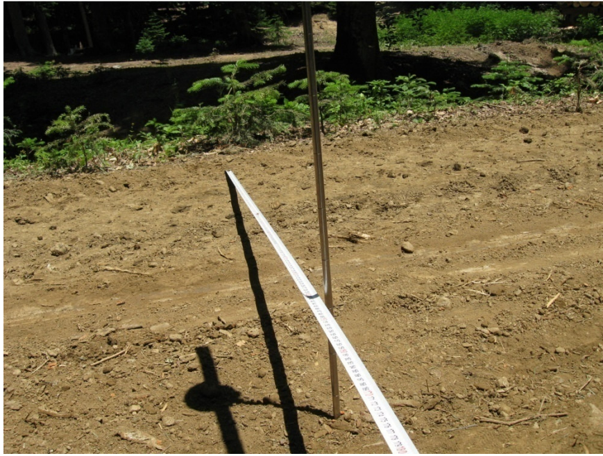
Şekil 17. Sürütme şeridinde oluşan toprak kaybının ölçülmesi
