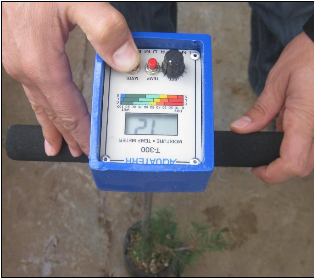
Şekil 9. Nem ve sıcaklık ölçer aletiyle (T-300 moisture-temperature meter) toprak sıcaklığı ve neminin ölçülmesi
