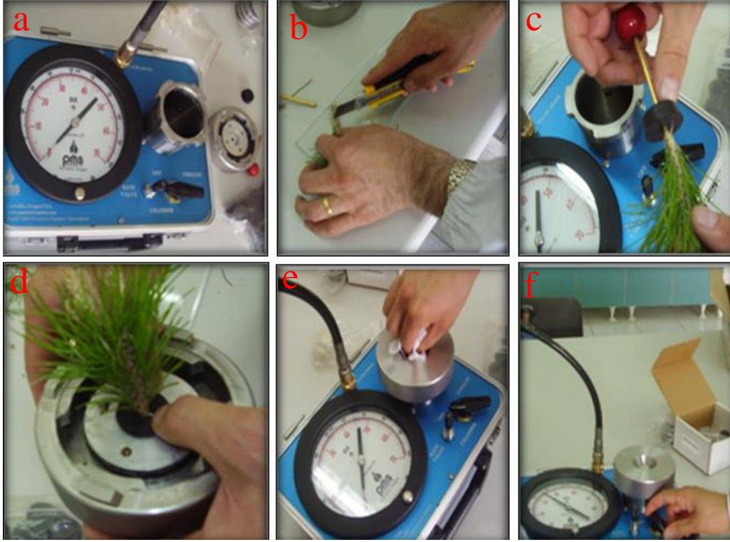
Şekil 10. Basınç odası tekniği ile bitki su potansiyelinin ölçülmesi; PMS cihazı (a) Fidanın ölçüm için hazırlanması (b), Fidanın ölçüm için kauçuk contaya yerleştirilmesi (c), Fidanın basınç odası cihazına yerleştirilmesi (d, e) Ölçümün yapılması (f)
