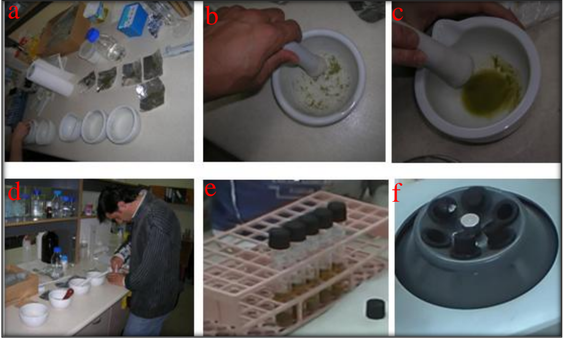
Şekil 12. Toplam karbohidrat ölçümü için numunenin hazırlanması; Kuru ibre örneklerinin cam kırıklar ile birlikte porselen havanda öğütülmesi (a, b), Öğütülmüş kuru ibre örneklerine etanol ilave edilmesi (c, d), Etanol eklenmiş öğütülmüş ibre örneklerinin vida kapaklı cam tüplere aktarılması ve santrifüj edilmesi (e, f).
