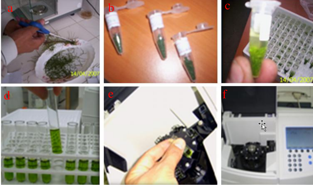
Şekil 11. Klorofil ölçümünün yapılması; Kök boğazından kesilen fidanların makasla ibrelerinin kesilmesi (a), küçük parçacıklara doğranmış ibrelerden 0,1 gr örnek alınması (b), Örneklerin Eppendorf tüplere doldurulup % 80 aseton ilave edilmesi (c), Örneklerin cam tüplere aktarılıp aseton ile 5 kat seyreltilmesi (d) Örneklerin küvetlere aktarılması (e), Spektrofotometrede örneklerin ölçümünün yapılması (f).
