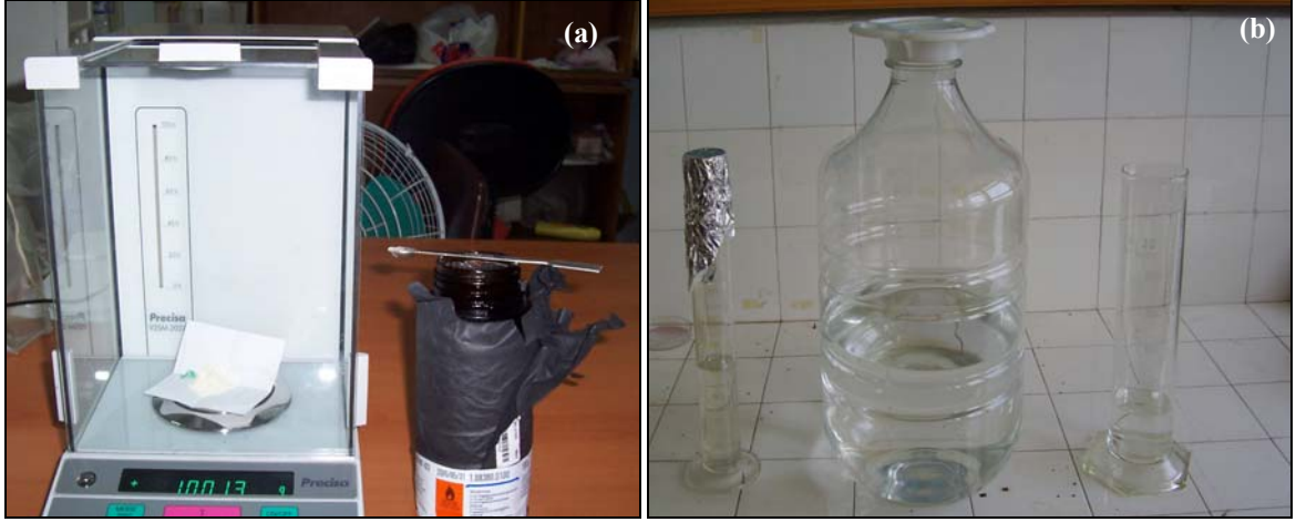
Şekil 8. Tetrazolium tuzunun tartılması (a) ve saf su ile karıştırılarak çözeltinin hazırlanması (b)
