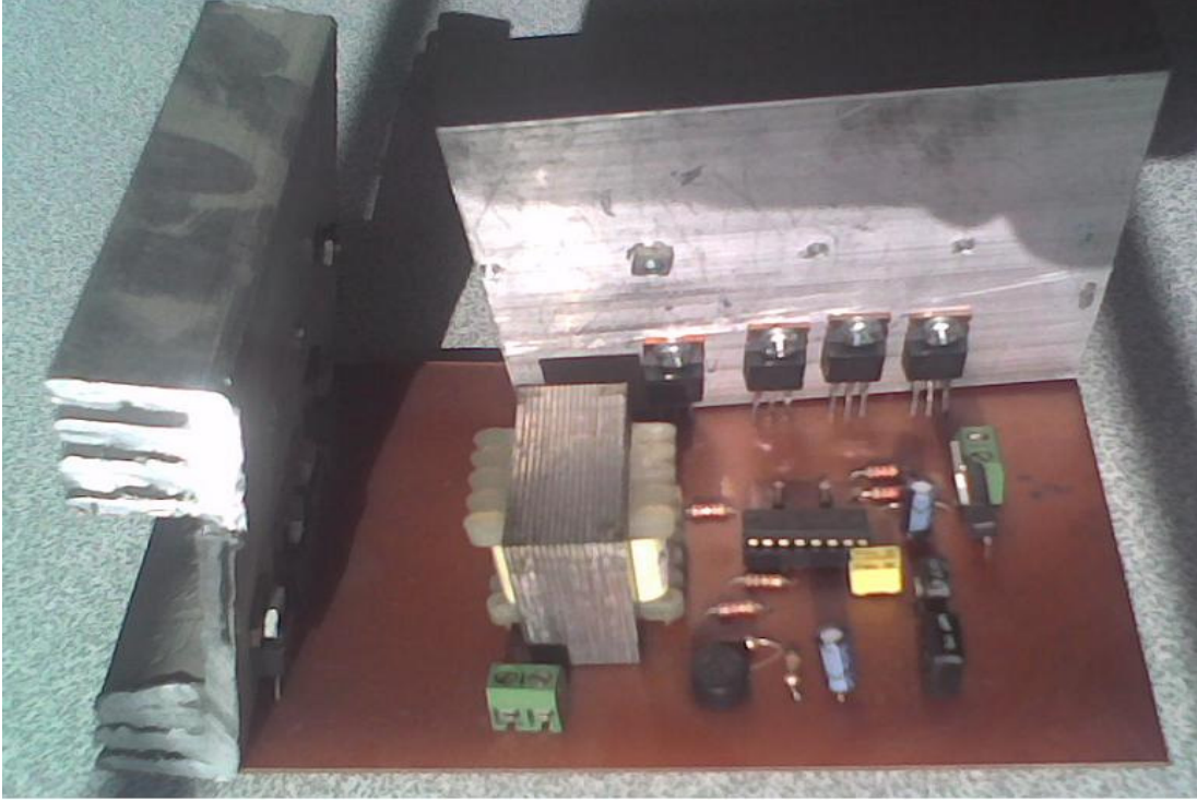
Şekil 2.13. İverter devresi montaj hali
