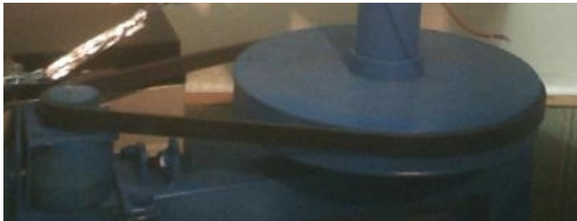
Şekil 2.28. STEP Motor x1-x2 yönlendirme mekanizması
