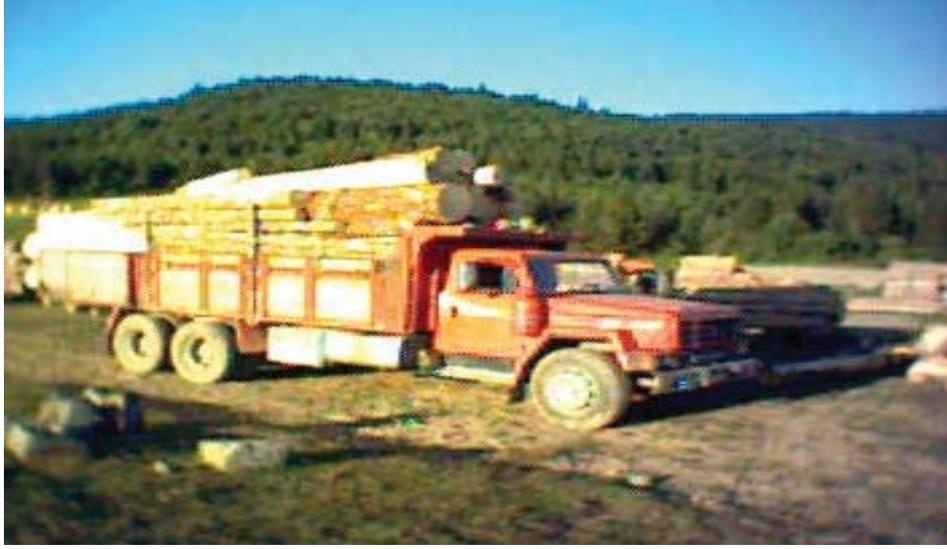
Şekil 8. Orman yolları üzerinde odun hammaddesinin kamyonla taşınması
