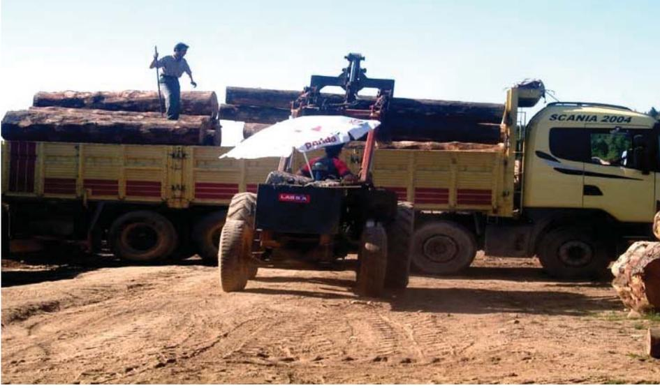
Şekil 6. Traktöre monteli ekipman ile odun hammaddesinin boşaltılması
