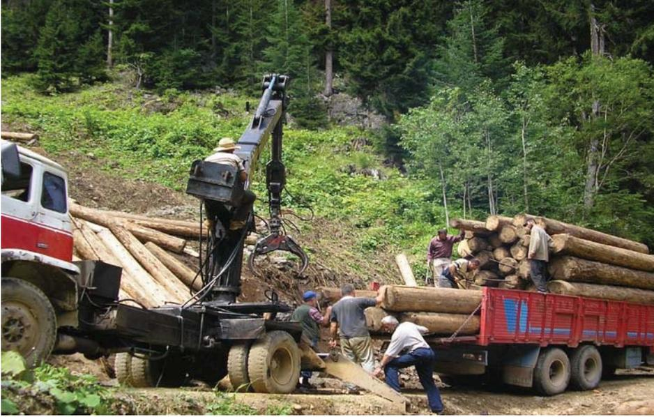
Şekil 5. Granab yükleyici ile odun hammaddesinin kamyonlara yüklenmesi
