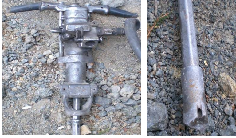
Şekil 19. Kaya delme tabancası (martoperfaratör) ve matkap keski ucu
