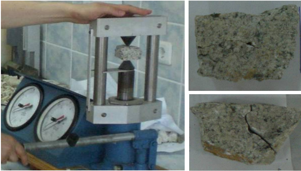
Şekil 83. Nokta yükü dayanımı deneyi ve geçerli kırılmanın olduğu örnekler
