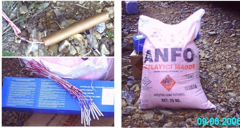
Şekil 20. Kullanılan Jelatinit dinamit, elektrikli kapsüller ve ANFO
