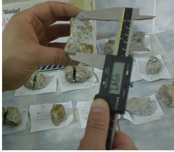
Şekil 24. Dijital kumpasla numunenin kırılma yüzeyi ölçümü
