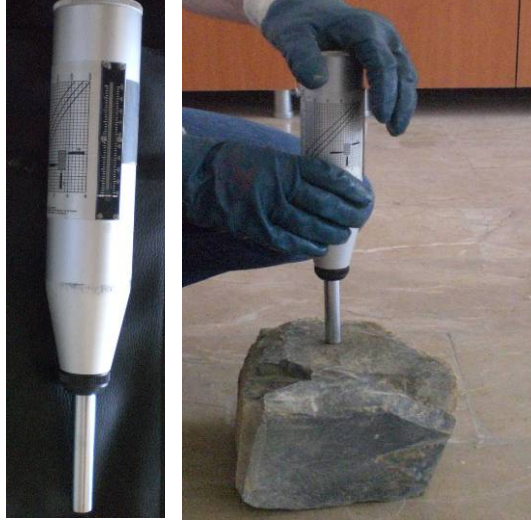
Şekil 25. Schmidt çekici ve blok numunede sertlik ölçümü
