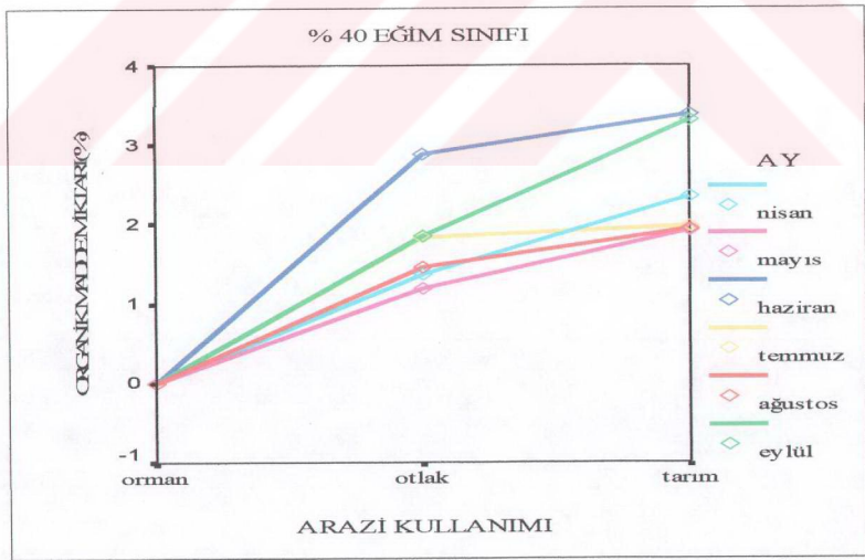
Şekil 68. % 40 eğim sınıfında aşınımına uğramış toprak örneklerindeki organik madde miktarları homojenlik testi sonuçlarının aylara göre değişimi
