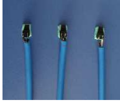
Şekil 39. Ses kanalı ölçümü için kullanılan mikrofon dizisi
