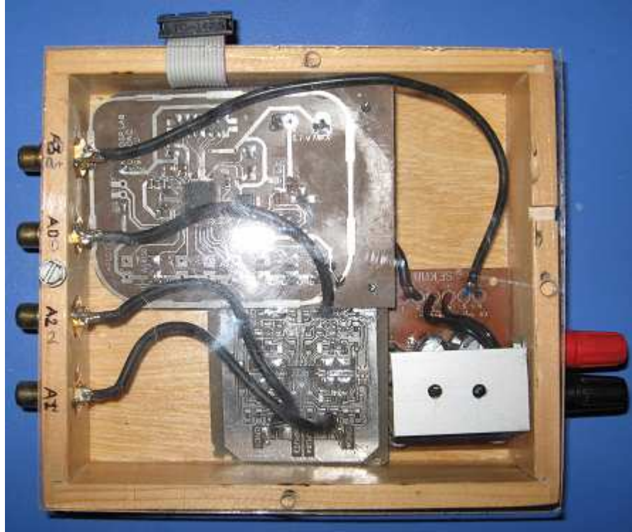
Şekil 37. Ses kanalının ölçülmesi için yapılan donanımın fotoğrafı
